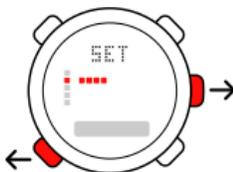
Выход из меню осуществляется нажатием кнопки [Start Stop]. Кнопка для быстрого выхода отмечена значком "X" на экране.
