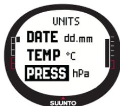
Le paramètre Press définit l'unité dans laquelle la pression barométrique est affichée. Les options possibles sont hPa et inHg.
