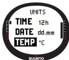
Le paramètre Temp permet de choisir l'unité dans laquelle les températures sont affichées. Les options possibles sont Celsius (°C) et Fahrenheit (°F).
