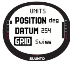
Le paramètre Grid permet de choisir le quadrillage à utiliser (pour en savoir plus sur les différents quadrillages, voir l'annexe Liste des quadrillages locaux).
