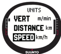
Le paramètre Speed définit l'unité dans laquelle les vitesses sont affichées. Les options possibles sont les kilomètres-heure (km/h) et les miles-heure (mph).
