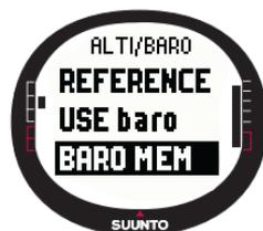
La fonction Baro mem enregistre les informations météo (pression barométrique réduite au niveau de la mer et température) des derniers 7 jours/168 heures. Chaque jour possède deux pages d'informations séparées. Une page pour la pression barométrique et une autre pour la température.
