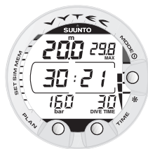
Bild 3.28. Dykning i Gauge-läge. Aktuell dyktid är 30 minuter och 21 sekunder.
