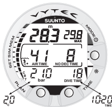
Bild 3.9. Dykdisplay. Aktuellt flasktryck är 210 bar och kvarvarande luft i tid är 41 minuter. Den alternativa displayen med aktuell tid och temperatur visas i 5 sekunder om du trycker på TIME.
