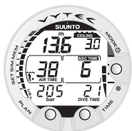
Bild 3.17. Dekompressionsdyk, över etappgolvet. Den uppåtriktade pilen har försvunnit och ASC TIME har slutat blinka, vilket innebär att du befinner dig inom vidden för dekompressionsstopp.
