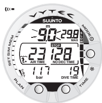
Bild 3.13. Indikator för uppstigningshastigheten. Djupangivelsen blinkar, SLOW och fyra segment visas och en ljudsignal hörs: uppstigningshastigheten är över 10 m/min. Detta är en upmaning att sakta ner! STOP-tecknet innebär att du ska göra ett obligatoriskt säkerhetsstopp när du når 6 meters djup.
