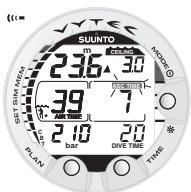
Bild 3.16. Dekompressionsdyk, under etappgolvet. Uppåtriktad pil, blinkande ASC TIME och en ljussignal anger att du ska gå uppåt. Minsta sammanlagda uppstigningstid inklusive säkerhetsstopp är 7 minuter. Etapptaket ligger på 3 meter.
