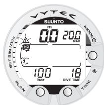
Bild 3.29. Display för ytintervall. Du har kommit till ytan efter ett 18 minuter långt dyk, där maxdjupet var 20 meter. Aktuellt djup är 0,0 meter. Flygplanssymbolen anger att du inte ska flyga, och det blinkande varningsmärket anger att du bör förlänga tiden för ytintervall på grund av ett överskott av mikrobubblor.
