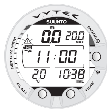
Bild 3.31. Ytintervall, tid då flygning avrådes. Om du trycker två gånger på TIME visas tiden då flygning avrådes tillsammans med en flygplanssymbol.
