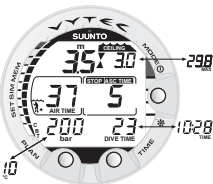
Bild 3.18. Dekompressionsdyk, vid zonen för etapptak. Två pilar pekar mot varandra (liknar ett timglas). Du befinner dig inom den optimala zonen för etapptak på 3,5 meter och kortaste tid för uppstigning är 5 minuter. Om du trycker på TIME aktiveras den alternativa displayen.
