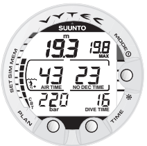
Bild 3.8. Dykdisplay. Aktuellt djup är 19,3 meter och maxtiden för direktuppstigning i läge A0/P1. Maxdjupet under dyket var 19,8 meter och förfluten dyktid är 16 minuter.
