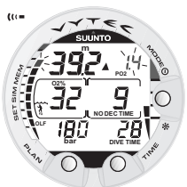
Bild 3.24. Display för syrets partialtryck och OLF. En ljudsignal hörs om syrets partialtryck stiger över 1,4 bar eller det inställda värdet och/eller om OLF när 80 %.
