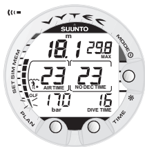
Bild 3.26. Det lägsta segmentet blinkar för att ange att OLF-värdet som visas gäller OTU.
