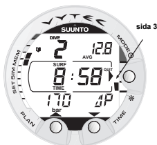
Bild 4.9. Loggbok, sida III. Tid för ytintervall, medeldjup och förbrukad luft markerat med Δ P.
