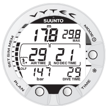
Bild 3.23. Dykning i Nitrox-läge. När lufttiden är mindre än 30 minuter ersätts O 2 av displayen för kvarvarande luft i tid.
