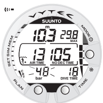
Bild 3.12. Varningar för lågt flasktryck. Trycket är lägre än 50 bar. Tryckdisplayen blinkar och en ljudsignal hörs.
