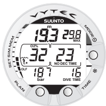
Bild 3.22. Dykning i Nitrox-läge. Värdet för O 2 är 32 %.
