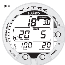
Bild 3.15. Ett obligatoriskt säkerhetsstopp har ignorerats. En nedåtriktad pil och en ljudsignal anger att du ska gå ned till zonen för etapptak.
