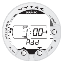
Bild 4.20. Simuleringsläget för dykplanering har valts. Lägg till önskad tid för ytintervall genom att trycka på knapparna TIME och PLAN. Denna display visas endast vid upprepad dykning.
