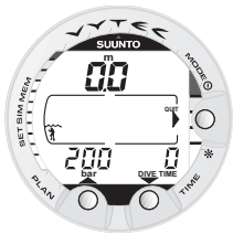
Bild 4.18. Dyksimuleringsläget har valts. Du går djupare genom att trycka på nedåtknappen (TIME), och du går grundare genom att trycka på uppåtknappen (PLAN).
