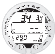
Bild 3.7. Dyket har just börjat och ingen kvarvarande luft i tid visas.
