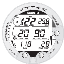
Bild 3.10. Aktivering av bokmärke. En anteckning, eller ett bokmärke, placeras i minnet för dykprofil om du trycker på PLAN under dyket. Observera loggbokssymbolen.
