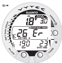
Bild 3.19. Dekompresionsdyk, över etapptaget. Observera den nedåtriktade pilen, varningen Er och ljudsignalen. Du ska omedelbart (inom tre minuter) gå ner till eller under djupet för etapptak.
