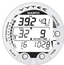
Bild 3.25. Alternativ display. Om du trycker på TIME visas aktuell tid, maxdjup, temperatur, CBT och O 2 % om kvarvarande luft i tid understiger 30 minuter.
