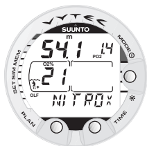
Bild 3.21. Nitrox-display. Maxdjupet, som baseras på inställt värde för O_2\% (21 %) och PO_2 (1,4 bar), är 54,1 meter.
