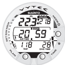
Bild 3.15b Djupstopp. Pilarna visar att du är på djupet för djupstoppet. 59 sekunder återstår tills stoppet är utfört.
