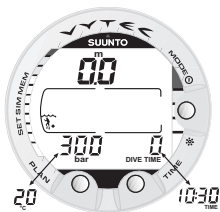
Bild 3.3. Igångsättning III. Ytläge. Djup och dyktid är noll och flasktrycket är 300 bar. Om du trycker på TIME aktiveras den alternativa displayen med temperatur och aktuell tid.
