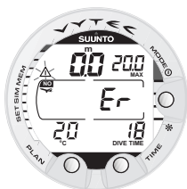
Bild 3.32. Ytläge efter att etapptak under ett dekompansionsdyk har ignorerats. Symbolen Er anger att du har ignorerat ett etapptak i mer än tre minuter. Du ska inte dyka igen under minst 48 timmar.
