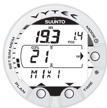
Bild 3.27. Byte av gasblandning. Aktuell blandning är MIX1 (21 %). Bläddra mellan aktiverade blandningar genom att trycka på PLAN eller TIME. Välj en ny blandning genom att trycka på MODE (OK).
