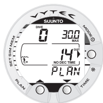
Bild 3.6. Dykplanering. Planeringsläget anges med texten PLAN. Den maximalt tillåtna tiden för direktuppstigning för 30 meter är 14 minuter i läge A0/P1.
