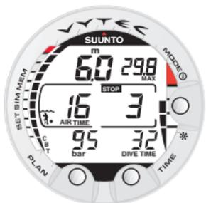
Fig. 3.11. Sosta raccomandata di fine immersione di 3 minuti
