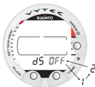
Fig. 4.25b. Settaggio Sosta di Fine Immersione/Deepstop. Premere i pulsanti PLAN e TIME per effettuare la scelta fra Sosta di Fine Immersione/Deepstop.
