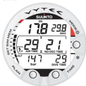
Fig. 3.23. In immersione in Nitrox. Quando l'autonomia d'aria è inferiore a 30 minuti, la % O<sub>2</sub> è sostituita dall'indicazione dei minuti di autonomia d'aria
