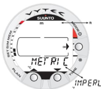
Fig. 4.34. Settaggio del sistema di misura (metrico/anglosassone).
