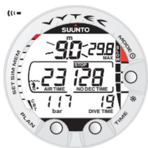
Fig. 3.13. Indicatore di velocità di risalita. Le indicazioni: profondità attuale lampeggiante, l'apparire della scritta SLOW, i quattro segmenti attivi contemporaneamente, unitamente ad un segnale acustico, indicano che la velocità di risalita supera i 10 m/min. [33 ft/min.]. È un allarme che indica di rallentare la risalita! La scritta STOP indica che il subacqueo deve effettuare una sosta di sicurezza obbligatoria quando raggiunge la profondità di 6 m. [20 ft].
