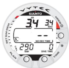
Fig. 3.7. L'immersione è appena iniziata ed il computer non indica alcun RAT, autonomia d'aria. La prima stima del RAT viene evidenziata dopo circa 60 secondi.
