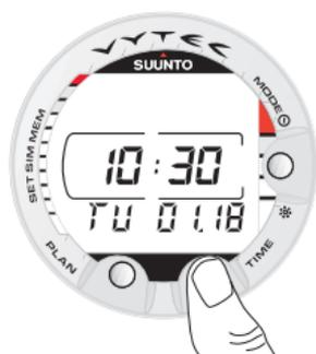
Fig. 2.1. Display Orologio. Si attiva il display premendo uno dei due pulsanti PLAN o TIME.
