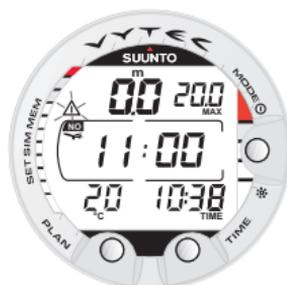
Fig. 3.31. Intervallo di superficie, tempo di non volo. Il dato, indicato con il simbolo dell'aereo, si evidenzia premendo due volte il pulsante TIME.
