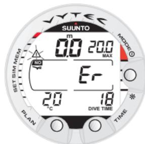
Fig. 3.32. Display in superficie dopo aver violato, per più di tre minuti, il Ceiling indicato dal computer. Viene evidenziato dalla scritta Er. Evitare di immergersi per almeno 48 ore.
