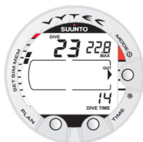
Fig. 4.14 Informazioni della Memoria storica. Numero totale di immersioni effettuate, ore di immersione e massima profondità mai raggiunta.
