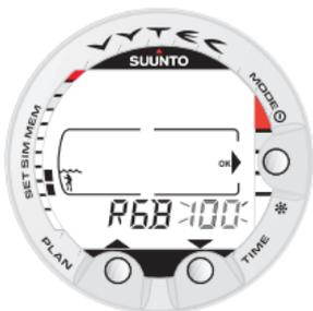
Fig. 4.25. Scelta RGBM. Premere i pulsanti PLAN e/o TIME per cambiare il settaggio.
