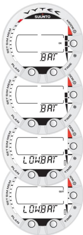
Fig. 3.2. Attivazione II. Indicatore di carica della batteria.
