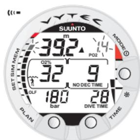
Fig. 3.24. Display di pressione parziale d'ossigeno e OLF. L'allarme acustico si attiva sia quando la PO<sub>2</sub> supera 1,4, o il diverso valore impostato, sia quando l'OLF raggiunge l'80%.
