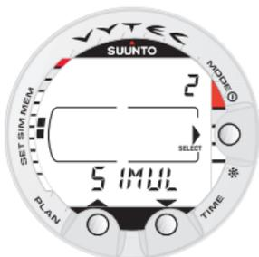
Fig. 4.3. Sottomenu Simulazioni [2 SIMUL]
