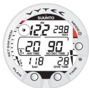
Fig. 3.10. Attivazione del Bookmark. In immersione è stata fatta una annotazione premendo il pulsante PLAN. È indicato dall'icona
