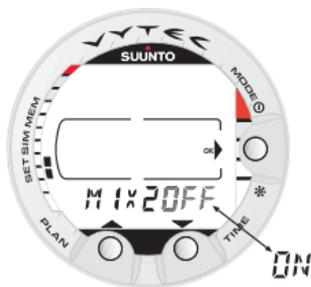
Fig. 4.29. Settaggio delle miscele aggiuntive (MIX2, MIX3). MIX 2 è settata su OFF. Attivare/disattivare MIX2 utilizzando i due pulsanti PLAN e TIME. Premere MODE (OK) per confermare i settaggi effettuati.
