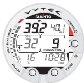
Fig. 3.25. Display alternativo. Premendo il pulsante TIME appaiono: l'ora, la profondità massima, la temperatura e, se il RAT è meno di 30 minuti, il CBT e l' $O_2\%$
