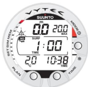
Fig. 3.30. Intervallo di superficie, display Superficie. Premendo il pulsante TIME una volta il computer mostra il display superficie.
