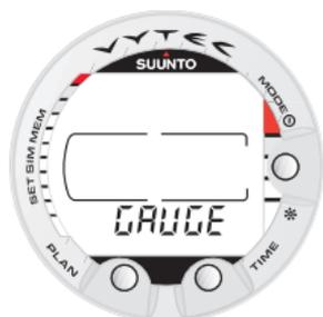
Fig. 3.4. Attivazione IV. Funzione Gauge (Profondimetro-Timer).
