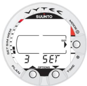
Fig. 4.22. Opzione Settaggio [3 SET]
