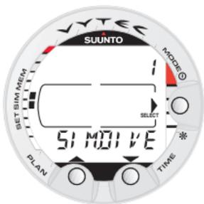
Fig. 4.17. Simulatore d'Immersione. [1 SIMDIVE].
