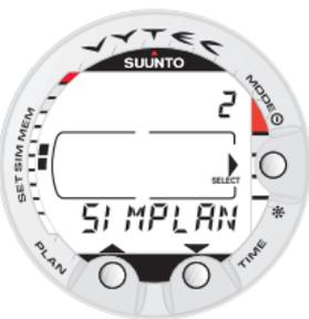
Fig. 4.19. Funzione Dive Planning Simulator [2 SIMPLAN]
