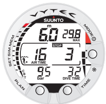
Fig. 3.11. Un palier de sécurité recommandé de 3 minutes.
