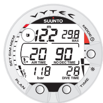
Fig. 3.10. Marquage activé. Le repère est placé sur un point du profil de la plongée en appuyant sur le bouton PLAN. Le symbole du carnet de plongée s'affiche au moment où vous appuyez.
