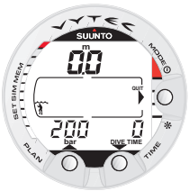
Fig. 4.18. Mode Simulateur plongée sélectionné. Pour descendre appuyez sur le bouton avec la flèche vers le bas (TIME) et pour remonter appuyez le bouton avec la flèche vers le haut (PLAN).
