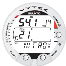
Fig. 3.21. Affichage nitrox. La profondeur maximale basée sur des réglages O2% (21%) et PO2 (1.4 bar) est de 54.1 m.
