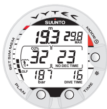
Fig. 3.22. Plongée nitrox. L'O2% est réglé à 32%.
