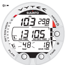
Fig. 3.12. Alarme de pression d'air. La pression est de 50 bar (725 PSI). L'affichage de la pression clignote et trois doubles BIP retentissent.
