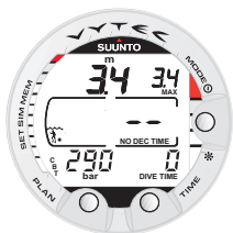
Fig. 3.7. La plongée commence et le temps d'autonomie en air n'est pas affiché. Le temps d'autonomie en air s'affiche après 30 à 60 secondes.
