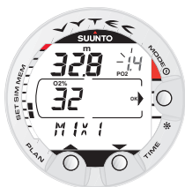
Fig. 4.28. Réglages du 1 er mélange (MIX1). Le pourcentage d'oxygène est de 32% et la pression partielle est de 1.4 bars. La profondeur maximale équivalente est de 32.8 m. Pour changer la valeur d'oxygène et de pression partielle, appuyez sur les boutons de défilement. Validez les valeurs en appuyant sur le bouton Mode (OK).
