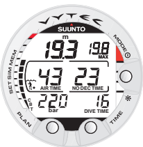
Fig. 3.8. Affichage en plongée. La profondeur est de 19.3 m, le temps de plongée sans palier est de 23 minutes en mode A0/P1. La profondeur maximale de la plongée est de 19.8 m et le temps d'immersion est de 16 minutes.
