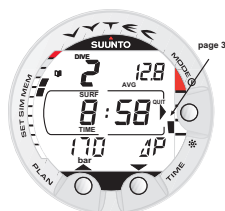
Fig. 4.9. Carnet de plongée, page III. Intervalle surface, profondeur moyenne et consommation en air indiquée par P.
