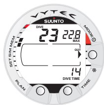
Fig. 4.14. Paramètres de la Mémoire Historique. Nombre total de plongées, nombre d'heures et profondeur maximale.
