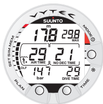
Fig. 3.23. Plongée nitrox. Lorsque l'autonomie en air est inférieure à 30 minutes, elle s'affiche en lieu et place du O2%.
