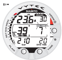
Fig. 3.16. Plongée avec paliers de décompression en dessous de la profondeur plancher. La flèche pointant vers le haut, la mention clignotante ASC TIME et l'alarme sonore vous recommandent de remonter. La durée totale de remontée minimale incluant le palier de sécurité est de 7 min. La profondeur plafond est à 3 m.
