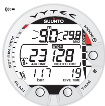
Fig.3.13. Indicateur de vitesse de remontée. Profondeur courante clignotante, mention SLOW et 4 segments affichés : la vitesse de remontée est supérieure à 10 m/min. Il faut ralentir. Le signal STOP signifie que vous devez effectuer un palier de sécurité obligatoire lorsque la profondeur sera de 6 m.
