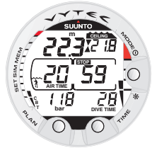
Fig. 3.15b Les flèches indiquent que vous êtes à la profondeur du palier. Il reste 59 secondes avant la fin du palier.
