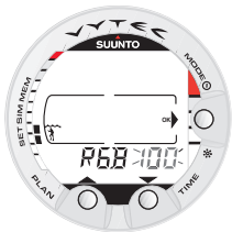
Fig. 4.25. Réglage du RGBM. Appuyez sur les boutons de défilement pour changer le modèle.
