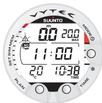
Fig. 3.31. Interface surface, temps d'attente avant déplacement aérien. En appuyant sur le bouton TIME deux fois vous obtenez le temps d'attente avant déplacement aérien indiqué par le symbole en forme d'avion.
