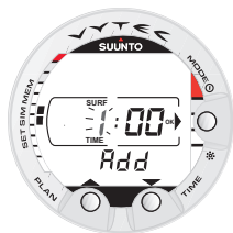
Fig. 4.20. Mode Simulateur planning sélectionné. Régler l'intervalle surface à l'aide des boutons TIME et PLAN. Cet affichage n'est possible qu'avec des plongées successives.
