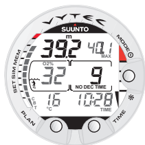
Fig. 3.25. Affichage alterné. En appuyant sur le bouton TIME l'heure, la profondeur maximale, la température, le CBT (temps de plongée écoulé) et le O2%, si l'autonomie en air est inférieure à 30 min, s'affichent.
