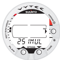
Fig. 4.16. Le simulateur de plongée. [2 SIMUL].
