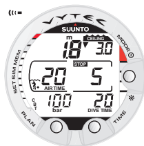
Fig. 3.15. Palier de sécurité obligatoire non respecté. La flèche vers le bas et l'alarme sonore vous informe qu'il faut redescendre à la profondeur indiquée par la mention CEILING.
