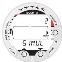
Kuva 4.3. Simulaatio-tilan valinta. [2 SIMUL].
