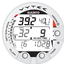
Kuva 3.25. Vuorotteleva näyttö. Painamalla TIME-painiketta näytölle tulee nykyinen kellonaika, enimmäissyvyys, lämpötila, CBT ja O 2 %, jos ilma-aikaa on jäljellä vähemmän kuin 30 minuuttia.
