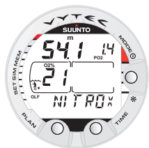
Kuva 3.21. Nitroksinäyttö. Asetettuihin happipitoisuuden (21%) ja hapen osapaineen (1,4 bar) arvoihin perustuva enimmäissyvyys on 54,1 m.
