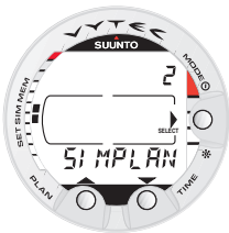
Kuva 4.19. Sukelluksen suunnittelun simulaattoritila. [2 SIMPLAN].
