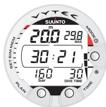
Kuva 3.28. Sukellusmittaritilassa. Tämänhetkinen sukellusaika on 30 minuuttia 21 sekuntia.
