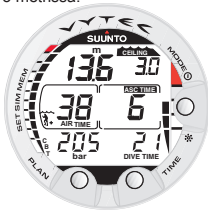
Kuva 3.17. Suoranoususukellus lattian yläpuolella. Ylöspäin osoittava nuoli on hävinnyt näytöltä, ja ASC TIME -merkkintä on lakannut vilkkumasta, mikä tarkoittaa sitä, että olet suoranousu-alueella.
