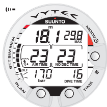
Kuva 3.26. Alin pylväsdiaagrammi vilkkuu merkinä siitä, että näytetty happikertymän (OLF) arvo koskee happitoleranssia (OTU).
