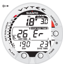
Kuva 3.19. Suoranousu-sukellus, katon yläpuolella. Huomaa alaspäin osoittava nuoli, Er -varoitusta sekä äänihälytys. Sinun tulisi välittömästi (3 minuutin kuluessa) laskeutua kattosyvyyteen tai sen alapuolelle.
