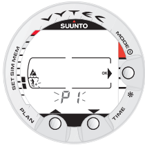
Kuva 4.24. Henkilökohtaisen säädön asetus. Paina selauspainikkeita halutessasi muuttaa henkilökohtaista säätöä.
