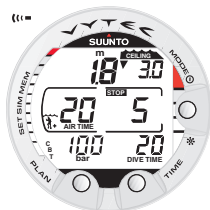
Kuva 3.15. Pakollista turvapysähdystä ei ole noudatettu. Alaspäin osoittava nuoli ja äänihälytys ilmoittavat, että sinun tulisi laskeutua kattovyöhykkeelle.
