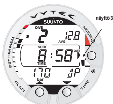
Kuva 4.9. Lokikirjan näyttö III. Sukellusten välinen pinta-aika, keskimääräinen syvyys sekä kulutettu ilma, jota osoittaa symboli P.
