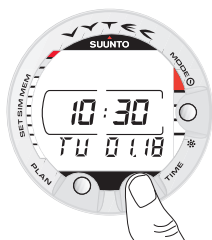
Kuva 2.1. Kellonajan näyttö. Näyttö aktivoituu, kun painetaan PLAN tai TIME-painiketta.
