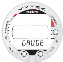
Kuva 3.4. Käynnistys IV. Mittaritila.
