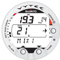
Kuva 3.27. Kaasuseoksen vaihtaminen. Nykyinen kaasuseos on MIX1 (21%). Selaa käytettävissä olevien kaasujen välillä painamalla PLAN tai TIME -painiketta. Valitse uusi seos painamalla MODE (OK) -painiketta.
