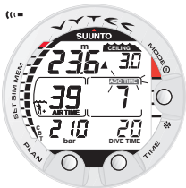
Kuva 3.16. Suoranoususukellus lattian alapuolella. Ylöspäin osoittava nuoli, vilkkuva ASC TIME -merkki sekä äänihälytys ilmoittavat, että sinun tulee nousta. Yhteenlaskettu vähimmäisnousuaika turvapysähdykset mukaan luettuna on 7 minuuttia. Katto on 3 metrissä.
