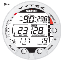
Kuva 3.13. Nousuno-peuden mittari. Vilkkuva syvyytlukema, SLOW ja neljä segmenttiä näy-tetään yhdessä äänihälytyk-sen kanssa: nousunopeus on yli 10 m/min. Tämä on varoitus, että sinun tulee hidastaa nousuno-peuttasi! STOP -merkki tar-koittaa sitä, että sinua neuvotaan pitämään pakollinen turvapysähdyks, kun saavutat 6 metrin syvyyden.
