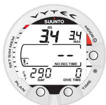
Kuva 3.7. Sukellus on juuri alkanut, eikä ilma-aikaa näytetä. Ensimmäinen arvio jäljellä olevasta ilma-ajasta näytetään 30-60 sekunnin kuluttua.
