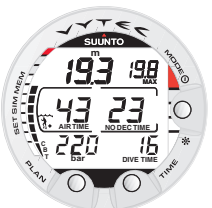
Kuva 3.8. Sukellusnäyttö. Tämänhetkinen sy-vyyys on 19,3 metriä, ja suoranousu-ajan raja on 23 minuuttia A0/P1 -tilassa. Tämän sukelluksen aikana enimmäissyvyys oli 19,8 metriä ja kulunut sukellusaika on 16 minuuttia.
