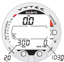
Kuva 3.3. Käynnistys III. Pintatila. Syvyys ja sukellusaika ovat nollassa ja säiliön paine on 300 bar. Painamalla TIME -painiketta aktivoit lämpötilan ja nykyisen kellonajan vuorottelevan näytön.
