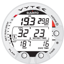
Kuva 3.22. Sukeltaminen nitroksitilassa. Happipitoisuuden arvoksi on asetettu 32%.
