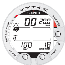
Kuva 3.29. Pintanäyttö. Olet pintautunut 18 minuutin sukellukselta, jonka enimmäissyvyys oli 20,0 m. Tämänhetkinen syvyys on 0,0 m. Lentokonesymboli on merkinä siitä, että sinun ei tulisi lentää ja vilkkuva sukeltajan huomiomerkki ilmoittaa, että sinun tulisi pidentää pinta-aikaasi liian suuren mikrokuplamäärän vuoksi.
