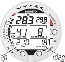
Kuva 3.9. Sukellusnäyttö. Tämänhetkinen säiliöpaine on 210 bar, ja jäljellä oleva ilma-aika on 41 minuuttia. Nykyisen kellonajan ja lämpötilan vuorotteleva näyttö näytetään 5 sekunnin ajan sen jälkeen, kun TIME -painiketta on painettu.
