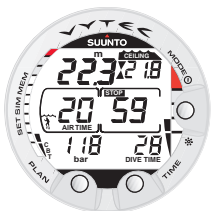
Kuva 3.15 b Syväpysähdys. Nuolet osoittavat että olet syväpysähdysten syvyydessä. Syväpysähdysten suorittamiseen on jäljellä 59 sekuntia.
