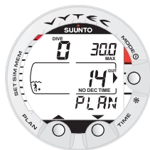
Kuva 3.6. Sukelluksen suunnittelu. Suunnittelutila ilmoitetaan PLAN-tekstillä. Suoranousajan rajana 30,0 metrissä on 14 minuttia A0/P1 -tilassa.
