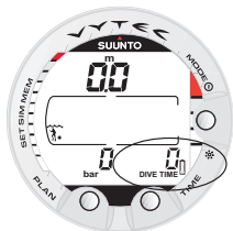
Kuva 3.5. Pariston alhaisen jännitteen varoitus. Paristosymboli on merkinä siitä, että pariston jännite on alhainen ja että paristonvaihto on suositeltavaa.
