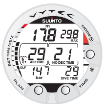
Kuva 3.23. Sukeltaminen nitroksitilassa. Sen jälkeen kun ilma-aikaa on jäljellä vähemmän kuin 30 minuuttia, ilma-ajan näyttö korvaa hap-pipitoisuuden näytön.
