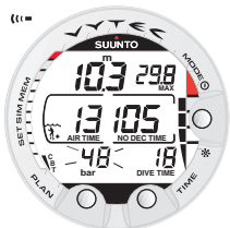
Kuva 3.12. Säiliöpaineen varoitukset. Paine on pudonnut alle lukeman 50 bar. Paineen näyttö vilkkuu ja kuuluu äänihälytys.
