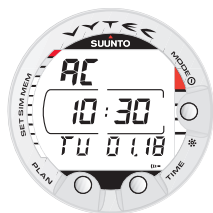
Kuva 2.4. AC -teksti on merkinä aktiivisista vesikontakteista.
