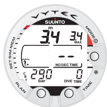
Fig. 3.7. Comienza la inmersión y no se visualiza el tiempo de autonomía de aire. El tiempo de autonomía de aire se visualiza tras un intervalo de entre 30 y 60 segundos.
