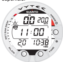
Fig. 3.31. Pantalla superficie, tiempo de espera antes de un desplazamiento aéreo. Pulsando dos veces el botón TIME, se visualiza el tiempo de espera antes de realizar un desplazamiento aéreo, indicado por el símbolo de avión.
