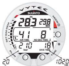
Fig. 3.9. Visualización durante la inmersión. La presión de aire es de 210 bar y el tiempo de autonomía de aire es de 41 minutos. Pulsando el botón TIME, se visualizan la hora y la temperatura durante 5 segundos.
