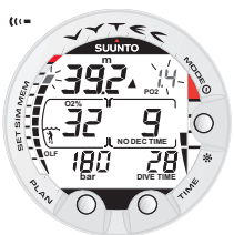
Fig. 3.24. Visualización de la presión parcial de oxígeno y del indicador OLF. Cuando la presión parcial de oxígeno supera los 1,4 bar o el parámetro seleccionado, y el indicador OLF alcanza el 80 %, se dispara una alarma acústica.
