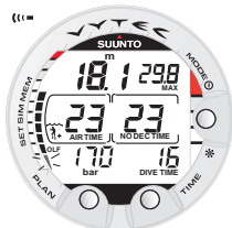
Fig. 3.26 La OTU ha alcanzado el límite de toxicidad SNC. El segmento inferior comienza a parpadear y se dispara la alarma acústica.
