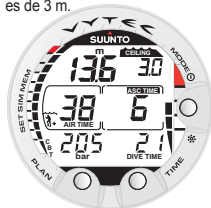
Fig. 3.17. Inmersión con paradas de descompresión, por encima de la profundidad base. La flecha ha desaparecido y la indicación ASC TIME ya no parpadea. Se encuentra usted en la zona de descompresión.
