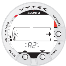
Fig. 4.23. Ajuste de altitud. Pulse los botones de desplazamiento para cambiar la zona de altitud.
