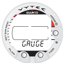
Fig. 3.4. Pantalla puesta en marcha IV. Utilización en modo profundímetro.
