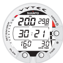
Fig. 3.28. Utilización como profundímetro durante la inmersión. El tiempo de inmersión es de 30 minutos y 21 segundos.
