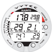
Fig. 3.23. Buceo en modo Nitrox. Cuando la autonomía del aire es inferior a 30 minutos, ésta se visualiza en lugar del porcentaje de oxígeno ( O_2 %).
