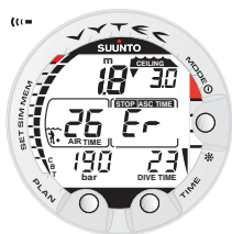
Fig. 3.19. Inmersión con paradas de descompresión, por encima de la profundidad tope. Se visualizan la flecha hacia abajo y la indicación de error Er. También se activa la alarma acústica. Debe volver a descender inmediatamente (en un tiempo máximo de 3 min) a la profundidad tope o por debajo de ésta.
