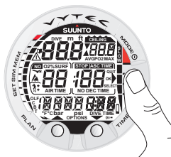
Fig. 3.1. Pantalla puesta en marcha I. Se visualizan todos los segmentos de la pantalla.
