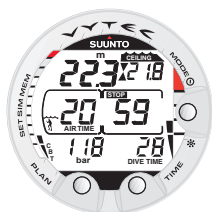
Fig. 3.15b La indicación de parada profunda, le indica que está en la profundidad de la parada profunda. Quedan 59 segundos para completar la parada profunda.
