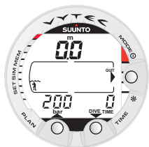
Fig. 4.18. Modo simulador de inmersión seleccionado. Para descender, pulse el botón con la flecha hacia abajo (TIME) y para ascender pulse el botón con la flecha hacia arriba (PLAN).
