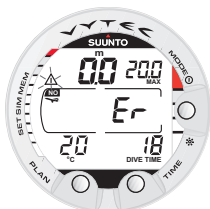
Fig. 3.32. Pantalla superficie después de una inmersión en la que no se han respetado los procedimientos de descompresión. La abreviación Er indica que la profundidad tope ha sido superada durante más de 3 minutos. No vuelva a bucear durante al menos 48 horas.
