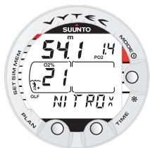
Fig. 3.21. Pantalla Nitrox. La profundidad máxima basada en los ajustes de O_2 (21%) y de PO_2 (1.4 bar) es de 54,1 m (177 pies).
