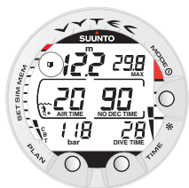
Fig. 3.10. Marcador activado. El marcador se señala en un punto del perfil de inmersión pulsando el botón PLAN. El símbolo del diario de buceo se visualiza cuando pulsa el botón.
