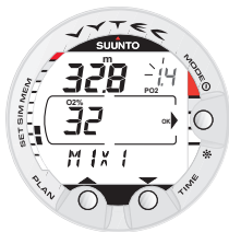
Fig. 4.28. Ajustes de la 1ª mezcla (MIX 1). El porcentaje de oxígeno es del 32 % y la presión parcial es de 1.4 bar. La profundidad máxima equivalente es de 32,8 m. Para cambiar los valores de oxígeno y de presión parcial, pulse los botones de desplazamiento. Seleccione los valores pulsando el botón MODE (OK).
