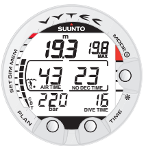
Fig. 3.8. Visualización durante la inmersión. La profundidad actual es de 19,3 m; el tiempo de inmersión sin descompresión es de 23 minutos en modo A0/P1. La profundidad máxima alcanzada durante la inmersión es de 19,8 m y el tiempo de inmersión es de 16 minutos.
