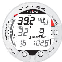
Fig. 3.25. Visualización alternativa. Pulsando el botón TIME, se visualizan en pantalla la hora actual, la profundidad máxima, la temperatura, el nivel de saturación CBT (tiempo de inmersión transcurrido) y el O 2 %, si la autonomía de aire es inferior a 30 minutos.
