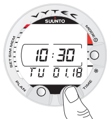
Fig. 2.1. La pantalla reloj. Pulse los botones PLAN o TIME para visualizar esta pantalla.
