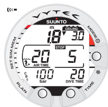
Fig. 3.15. No se ha respetado la parada de seguridad obligatoria. La flecha dirigida hacia abajo y la alarma acústica le indican que es necesario descender de nuevo a la profundidad señalada junto a la indicación CEILING.
