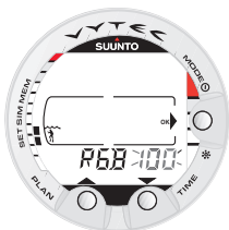
Fig. 4.25. Ajuste del RGBM. Pulse los botones de desplazamiento para cambiar el modelo.
