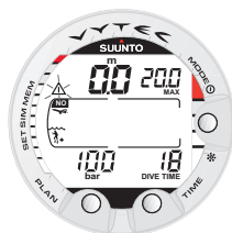
Fig. 3.29. Pantalla superficie. El buceador ha vuelto a la superficie después de una inmersión de 18 minutos a una profundidad máxima de 20,0 m. La profundidad actual es de 0,0 m. El símbolo del avión indica la prohibición de realizar un vuelo, y el símbolo Atención indica que debe prolongar el intervalo en superficie.
