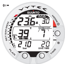
Fig. 3.16. Inmersión con paradas de descompresión, por debajo de la profundidad base. La flecha dirigida hacia arriba, el indicador intermitente ASC TIME y la alarma acústica le recomiendan ascender. El tiempo total de ascenso mínimo, incluida la parada de seguridad, es de 7 min. La profundidad tope es de 3 m.
