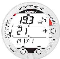
Fig. 3.27 Cambio de mezcla. La mezcla actual es el MIX 1 (21 %). Visualice las demás mezclas pulsando los botones PLAN o TIME. Seleccione una mezcla pulsando el botón MODE (OK).
