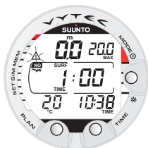
Fig. 3.30. Pantalla superficie, hora. Pulsando el botón TIME, vuelve al modo superficie.
