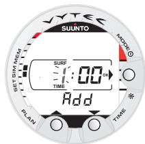
Fig. 4.20. Modo simulador de planificación seleccionado. Ajuste el intervalo en superficie con los botones TIME y PLAN. El intervalo en superficie sólo se visualiza en caso de inmersiones sucesivas.
