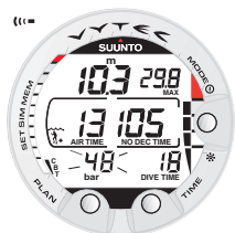
Fig. 3.12. Alarma de presión de aire. La presión es de 50 bar (725 psi). La visualización de la presión parpadea y suenan tres dobles "bips" acústicos.
