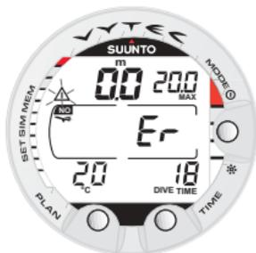
Bild 3.32. Ytläge efter att etapptak under ett dekompresionsdyk har ignorerats. Symbolen Er anger att du har ignorerat ett etapptak i mer än tre minuter. Du ska inte dyka igen under minst 48 timmar.
