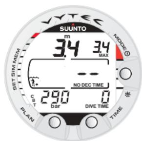
Bild 3.7. Dyket har just börjat och ingen kvarvarande luft i tid visas. Den första uppskattningen av detta visas efter 30–60 sekunder.
