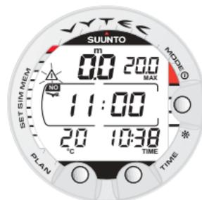
Bild 3.31. Ytintervall, tid då flygning avrådes. Om du trycker två gånger på TIME visas tiden då flygning avrådes tillsammans med en flyglanssymbol.
