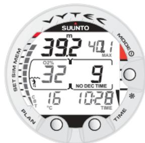
Bild 3.25. Alternativ display. Om du trycker på TIME visas aktuell tid, maxdjup, temperatur, CBT och O<sub>2</sub>% om kvarvarande luft i tid understiger 30 minuter.
