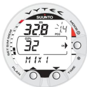
Bild 4.28. Inställning av primär gasblandning (MIX1). Syrgashalten är 32 % och syrets partialtryck är 1,4 bar. Motsvarande maxdjup visas som 32,8 meter. Tryck på scroll-knapparna för att ändra värdet för syrgashalt och ställa in syrets partialtryck. Godkänn inställningarna genom att trycka på MODE (OK).
