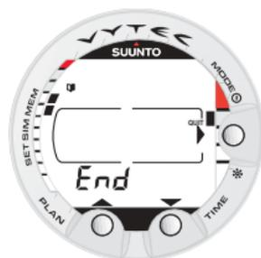
Bild 4.12. Loggbok, slut på minnet. Texten END visas mellan det äldsta och det senaste dyket.
