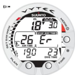
Bild 3.19. Dekompressionsdyk, över etapp-taket. Observera den nedåtriktade pilen, varningen Er och ljudsignalen. Du ska omedelbart (inom tre minuter) gå ner till eller under djupet för etaptak.
