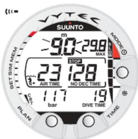
Bild 3.13. Indikator för uppstigningshastigheten. Djupangivelsen blinkar, SLOW och fyra segment visas och en ljudsignal hörs: uppstigningshastigheten är över 10 m/min. Detta är en uppmaning att sakta ner! STOP-tecknet innebär att du ska göra ett obligatoriskt säkerhetsstopp när du når 6 meters djup.
