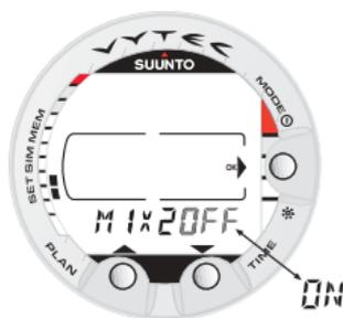
Bild 4.29. Inställning av ytterligare gasblandningar (MIX2, MIX3). MIX2 inaktiveras. Tryck på scroll-knapparna för att aktivera/inaktivera MIX2. Tryck på MODE (OK) för att godkänna inställningarna.
