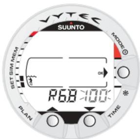
Bild 4.25. Justering av RGBM-läge. Tryck på scroll-knapparna för att byta läge.
