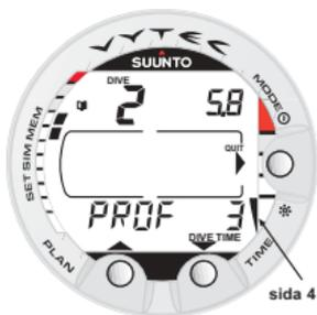
Bild 4.10. Loggbok, sida IV. Dykprofil för dyket.
