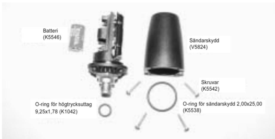
Bild 5.3. Den trådlösa sändarens delar. Koden står för reservdelsnumret.
