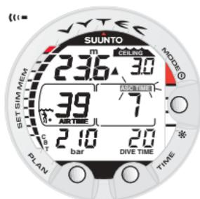
Bild 3.16. Dekompressionsdyk, under etappgolvet. Uppåtriktad pil, blinkande ASC TIME och en ljudsignal anger att du ska gå uppåt. Minsta sammanlagda uppstigningstid inklusive säkerhetsstopp är 7 minuter. Etapptaget ligger på 3 meter.
