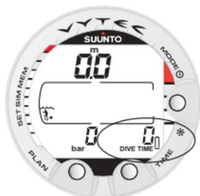
Bild 3.5. Varning för låg batterikapacitet. Battersymbolen anger att batterikapaciteten är låg och att batteribyte rekommenderas.
