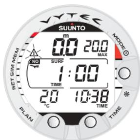
Bild 3.30. Ytintervall, tidsdisplay. Om du trycker en gång på TIME visas tidsdisplayen för ytintervall.
