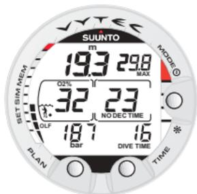
Bild 3.22. Dykning i Nitrox-läge. Värdet för  $O_2\%$  är 32 %.
