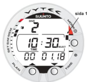
Bild 4.7. Loggbok, sida I. Bläddra till olika sidor för ett visst dyk.
