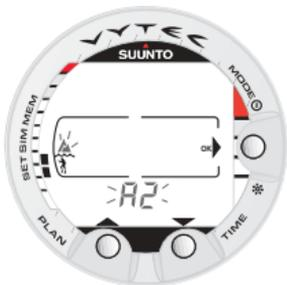
Bild 4.23. Justering för höghöjdsdykning. Tryck på scroll-knapparna för att byta läge.
