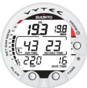
Bild 3.8. Dykdisplay. Aktuellt djup är 19,3 meter och maxtiden för direkt-uppstigning är 23 minuter i läge A0/P1. Maxdjupet under dyket var 19,8 meter och förfluten dyktid är 16 minuter.
