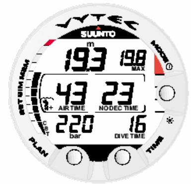
Fig. 3.8. Mostrador de Mergulho. A profundidade é de 19,3 m. O limite não descompressivo é de 23 min. (A0/P1). A profundidade máxima desse mergulho foi de 19,8 m e a duração desse mergulho é de 16 min..
