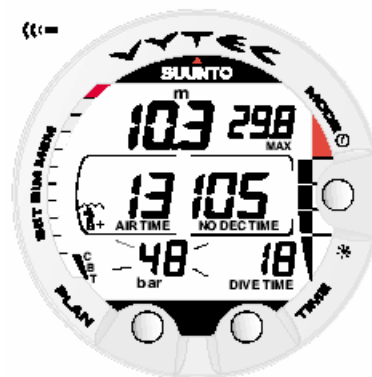
Fig. 3.12. Alarme de pressão de cilindro. Pressão está abaixo dos 50 bar. MOstrador de pressão está piscando e um sinal sonoro está ativado.
