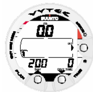
Fig. 4.18. Modo de Simulação de Mergulho selecionado. Simule a descida pressionando a seta para baixo (TIME) e a subida pressionando a seta para cima (PLAN).
