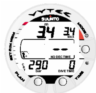
Fig. 3.7. Início do mergulho. Nenhum tempo de ar é mostrado. A primeira estimativa de ar restante aparecerá em torno de 30-60 segundos.
