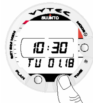
Fig. 2.1 Mostrador de Hora. Pressione o botão PLAN ou TIME para ativar o mostrador
