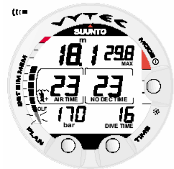
Fig. 3.26. O seguimento inferior do gráfico de barra pisca para indicar que o valor OLF está relacionada a OTU.
