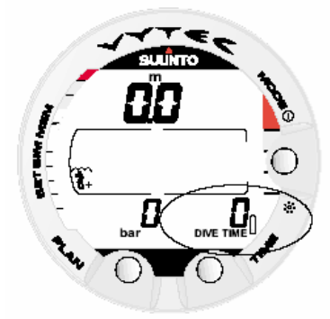
Fig. 3.5. Aviso de Bateria Fraca. O símbolo de bateria indica que a bateria está fraca e a troca é recomendada.
