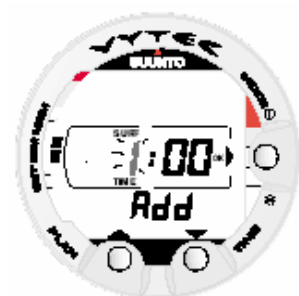
Fig. 4.20. Modo de Simulação do planejamento de Mergulho. Coloque o intervalo de superfície desejado. Nota: Esse mostrador só aparece em planejamento de mergulhos repetitivos.
