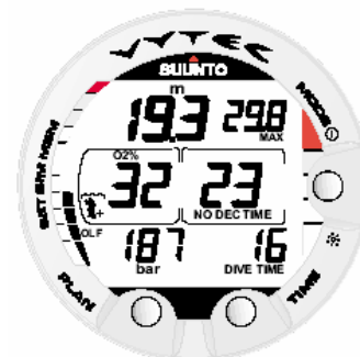
Fig. 3.22. Mergulhando no modo Nitrox. A %O 2 está configurada para 32%.
