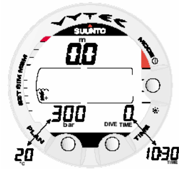
Fig. 3.3. Inicialização III. Modo de Superfície. A profundidade e o tempo de mergulho é igual a zero e a pressão do cilindro de 300 bar. Pressione os botões TIME para ativar as informações alternativas de temperatura e hora atual
