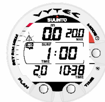
Fig. 3.30. Intervalo de superfície. Pressionando o botão TIME aparecerá o tempo de superfície
