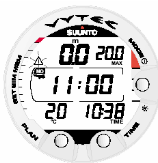
Fig. 3.31. Intervalo de superfície - Tempo de espera para o vôo. Pressionando o botão TIME 2 vezes mostrará o tempo de espera para o vôo indicado pelo ícone do avião.
