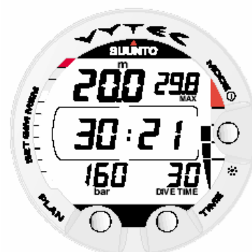
Fig. 3.28. Mergulhando no modo GAUGE . O tempo de mergulho é de 30 minutos e 21 segundos.
