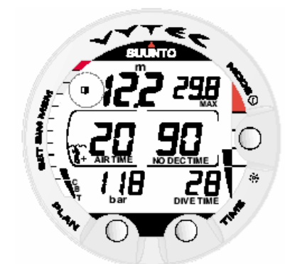
Fig. 3.10. Ativação do Marcador. Uma anotação é feita na memória do perfil durante o mergulho, pressionando o botão PLAN.
