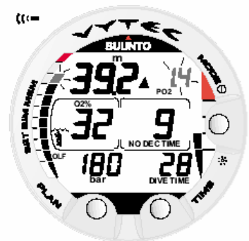
Fig. 3.24. Pressão parcial de Oxigênio e mostrador OLF. Haverá um alarme sonoro quando a pressão parcial for maior que 1,4 bar ou quando a porcentagem OLF chegar a 80%.
