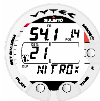
Fig. 3.21. Mostrador Nitrox . A profundidade máxima baseada em 21% O 2 e PO 2 de 1,4 é de 54,1 metros
