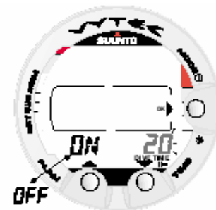
Fig. 4.26. Ajustando o alarme de tempo de mergulho. Pressione os botões PLAN e TIME para ativar/desativar o alarme e para ajustar o valor do tempo de mergulho.
