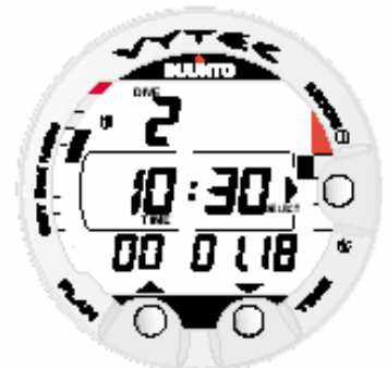
Fig. 4.11. LogBook. Pag. 1 Pressione o botão SMART 1 vez para navegar entre os diferentes mergulhos realizados.
