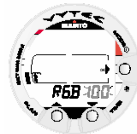
Fig. 4.25. Alterando o RGBM. Pressione os botões PLAN e TIME para mudar os ajustes.
