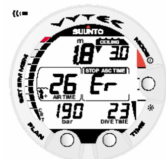
Fig. 3.19. Mergulho Descompressivo acima do teto. Note a seta apontando para baixo e o aviso de Er , além do sinal sonoro. Você deve descer abaixo do teto em até 3 minutos.
