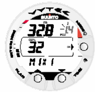
Fig. 4.28. Ajustando o MIX1 . A %O 2 é de 32% e a PO 2 é de 1,4bar. A profundidade máxima permitida é de 32,8 metros. Pressione os botões PLAN e TIME para alterar a %O 2 e PO 2 . Pressione MODE ( OK ) para confirmar.
