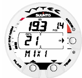
Fig. 3.27. Troca de mistura. A MIX1 é de 21%. Pressionando-se os botões PLAN ou TIME , as misturas são trocadas ( MIX2 , MIX3 ) e o botão MODE (OK) , confirma a mistura selecionada
