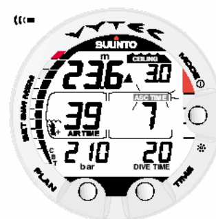
Fig. 3.16. Mergulho Descompressivo abaixo do piso. Uma seta apontando para cima e o texto ASC TIME sugerem que você suba. O tempo de subida total mínimo, incluindo a parada de segurança é de 7 minutos. O teto é de 3 metros.
