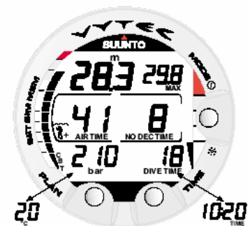
Fig. 3.9. Mostrador de Mergulho. Pressão do cilindro de 210 bar e tempo de ar restante de 41 minutos. Mostradores alternativos de hora e temperatura aparecem por 5 segundos ao se pressionar o botão TIME.
