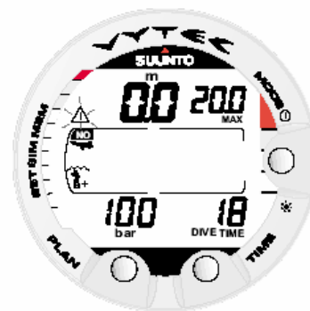
Fig. 3.29. Mostrador de superfície após um mergulho de 18 m. com uma profundidade máxima de 20 m. A profundidade atual é de 0.0 m. O ícone do avião indica que você não deve voar, e o símbolo de atenção ao mergulhador indica que você deve prolongar o seu tempo de superfície.
