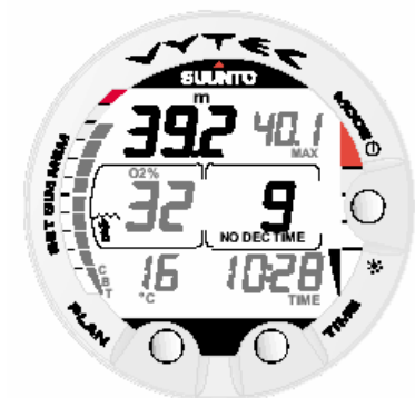
Fig. 3.25. Mostrador Alternativo. Pressionando o botão TIME irá aparecer a hora corrente, a profundidade máxima, CBT , e a %O 2 , se o tempo restante de ar for menor que 30 minutos.
