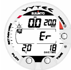
Fig. 3.32. Modo de Superfície após uma parada descompressiva violada. O símbolo Er indica que você violou a profundidade de teto por mais que 3 minutos. Você não deverá mergulhar por 48 horas.
