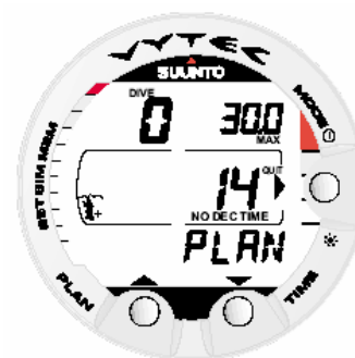
Fig. 3.6. Planejamento de Mergulho. O modo de planejamento é indicado pelo texto PLAN . O limite não descompressivo a 30 metros é de 14 minutos a A0/P1.
