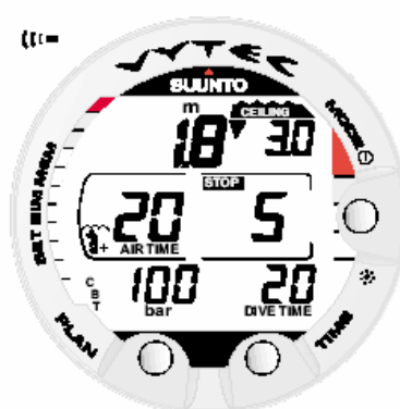
Fig. 3.15. Parada de Segurança Obrigatória Violada. Você deve descer a profundidade abaixo do teto.
