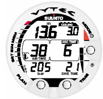
Fig. 3.17. Mergulho Descompressivo acima do piso. A seta apontando para cima desaparece e o texto ASC TIME pára de piscar, o que significa que você está na profundidade correta
