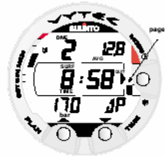
Fig. 4.9. LogBook. Pag. 3 O tempo de intervalo de superfície e a profundidade média e ar Consumido indicado por ΔP
