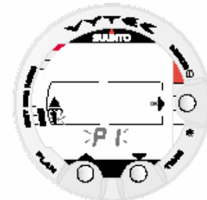
Fig. 4.24. Alterando os Ajustes Pessoais. Pressione os botões PLAN e TIME para mudar os ajustes pessoais.
