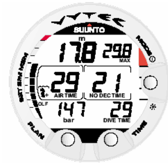
Fig. 3.23. Mergulho no modo Nitrox. Quando o tempo de ar é menor que 30 minutos, a %O 2 é substituída pelo tempo restante de ar
