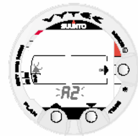
Fig. 4.23. Ajustando a Altitude. Pressione os botões PLAN e TIME para mudar a altitude.
