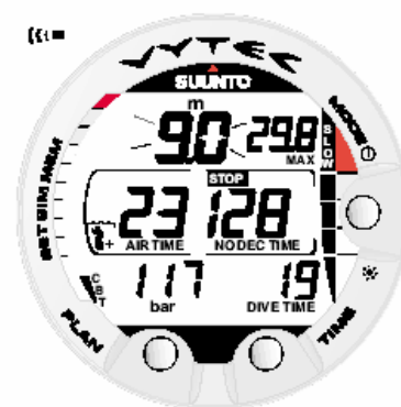
Fig. 3.13. Indicador de Velocidade de Subida. O texto SLOW e 4 segmentos são mostrados. A velocidade de subida é maior que 10 m/min. Esse é um aviso para que você diminua a velocidade. O texto STOP significa que uma parada de segurança obrigatória é necessária ao chegar a uma profundidade de 6 metros.
