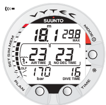
Fig. 3.26. Il valore dell'OTU supera quello del CNS. Il segmento inferiore lampeggia e si attiva l'allarme acustico.
