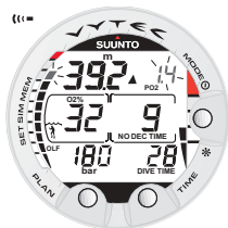
Fig. 3.24. Display di pressione parziale d'ossigeno e OLF. L'allarme acustico si attiva sia quando la PO_2 supera 1,4, o il diverso valore impostato, sia quando l'OLF raggiunge l'80%.
