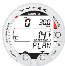
Fig. 3.6. Pianificazione. La scritta PLAN sul display indica che il computer è in pianificazione. Il tempo di non decompressione a m. 30,0, con personalizzazioni A0/P1, è 14 min.
