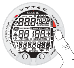
Fig. 3.1. Attivazione I. Sono visibili tutti i segmenti.
