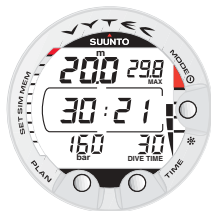
Fig. 3.28. Immersione in programma GAUGE. Il tempo d'immersione è 30 minuti e 21 secondi.
