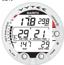
Fig. 3.23. In immersione in Nitrox. Quando l'autonomia d'aria è inferiore a 30 minuti, la % O_2 è sostituita dall'indicazione dei minuti di autonomia d'aria
