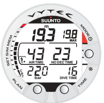
Fig. 3.8. Display in immersione. La profondità attuale è m. 19,3 [63 ft], il tempo di non decompressione, con personalizzazioni A0/P1, è 23 minuti. La massima profondità raggiunta è stata m. 19,8 [65 ft], il tempo trascorso in immersione è 16 minuti.
