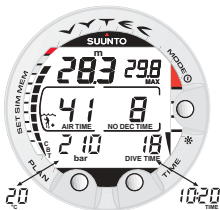
Fig. 3.9. Display in immersione. La pressione delle bombole è di 210 bar [3045 psi], l'autonomia d'aria è 41 minuti. Il display alternativo che indica ora e temperatura, si attiva, per 5 secondi, premendo il pulsante TIME.
