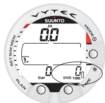
Fig. 3.5. Allarme di basso livello di carica della batteria. Il simbolo della batteria indica che il livello di carica della batteria è basso e se ne raccomanda la sostituzione.
