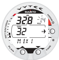
Fig. 4.28. Settaggio della miscela Nitrox primaria MIX1. La percentuale di Ossigeno è 32%, la pressione parziale di ossigeno è 1.4 bar. La corrispondente massima profondità ammissibile è evidenziata sul display ed è 32.8 m [107 ft]. Utilizzare i pulsanti per modificare la percentuale e/o la pressione parziale di ossigeno. Confermare i valori impostati premendo il pulsante MODE (OK).
