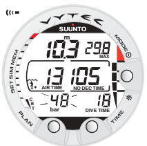
Fig. 3.12. Allarme di pressione bombole. La pressione è inferiore a 50 bar [725 psi]. Il valore della pressione lampeggia e si attiva un allarme acustico.
