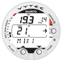
Fig. 3.27. Cambio di miscela. La miscela attuale è MIX1 (21%). Scorrere fra le miscele attivate utilizzando i pulsanti PLAN e TIME. Confermare la miscela prescelta premendo il pulsante MODE (OK).
