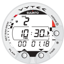
Fig. 4.11. Logbook, pagina I. Premere il pulsante MODE per poter scorrere fra le immersioni memorizzate.
