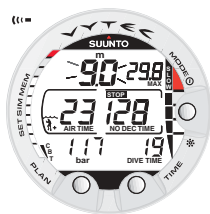
Fig. 3.13. Indichatore di velocità di risalita. Le indicazioni: profondità attuale lampeggiante, l'apparire della scritta SLOW, i quattro segmenti attivi contemporaneamente, unitamente ad un segnale acustico, indicano che la velocità di risalita supera i 10 m/min. [33 ft/min.]. È un allarme che indica di rallentare la risalita! La scritta STOP indica che il subacqueo deve effettuare una sosta di sicurezza obbligatoria quando raggiunge la profondità di 6 m. [20 ft].
