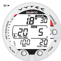
Fig. 3.15. Omissione della sosta di sicurezza obbligatoria. La freccia con la punta rivolta in basso ed un allarme acustico indicano che si deve ridiscendere alla profondità di Ceiling o al di sotto di questo.
