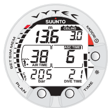
Fig. 3.17. immersione con decompressione, al di sopra di Floor. La freccia rivolta verso l'alto è scomparsa e la scritta ASC TIME ha smesso di lampeggiare, ciò indica che si è in Range di decompressione.
