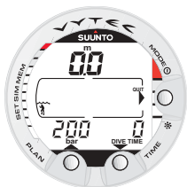
Fig. 4.18. Simulazione di un'immersione. Premere il pulsante TIME (freccia rivolta in basso) per "immergersi", per "risalire" premere il pulsante PLAN (freccia rivolta in alto).
