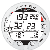
Fig. 3.22. In immersione in Nitrox. La percentuale di ossigeno è settata su 32%
