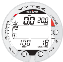
Fig. 3.29. Display Superficie. È stata effettuata una immersione di 18 minuti durante la quale si è raggiunta la profondità massima di 20,0 metri [66 ft]. La profondità attuale è 0,0 metri [0 ft]. Il simbolo dell'Aereo indica di evitare spostamenti utilizzando aerei. Il simbolo Attenzione lampeggiante indica che è opportuno prolungare l'intervallo di superficie a causa di un eccesso di formazione di Microbolle.
