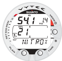
Fig. 3.21. Display Nitrox. La massima profondità ammissibile, basata sulla % O_2 (21%) e su PO_2 (1,4 bar), è m. 54,1.
