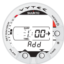
Fig. 4.20. Curva di sicurezza per l'immersione successiva. Premere i pulsanti PLAN e TIME per aggiungere tempo all'intervallo di superficie, indicato dallo strumento, fino a raggiungere l'intervallo di superficie desiderato. Questo display appare solo per pianificare una immersione successiva.
