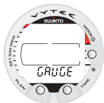
Fig. 3.4. Attivazione IV. Funzione Gauge (Profondimetro-Timer).
