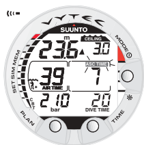
Fig. 3.16. Immersione con decompressione, più profondi di Floor. La freccia con la punta rivolta verso l'alto, la scritta ASC TIME lampeggiante ed un segnale acustico indicano che è opportuno risalire. Il tempo totale di risalita minimo, inclusa la sosta di sicurezza, è 7 minuti. Il Ceiling è a 3 m [10 ft].
