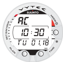
Fig. 2.4. La scritta AC sta ad indicare che i contatti bagnati sono attivi.
