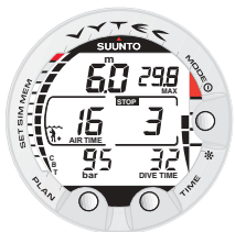
Fig. 3.11. Sosta raccomandata di fine immersione di 3 minuti
