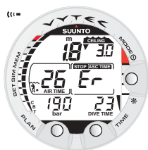
Fig. 3.19. Immersione con decompressione, al di sopra del Ceiling. Notare la freccia rivolta verso il basso, l'allarme Er ed un segnale acustico. Entro al massimo 3 minuti si deve ridiscendere alla profondità del Ceiling o più profondi.
