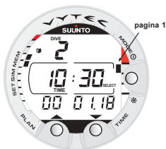
Fig. 4.7. Logbook, pagina 1, display principale. Utilizzando i pulsanti scorrere le altre pagine dell'immersione.
