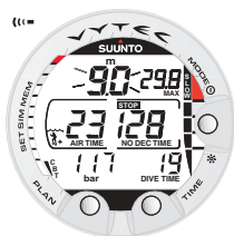
Fig.3.13. Indicateur de vitesse de remontée. Profondeur courante clignotante, mention SLOW et 4 segments affichés : la vitesse de remontée est supérieure à 10 m/min. Il faut ralentir. Le signal STOP signifie que vous devrez effectuer un palier de sécurité obligatoire lorsque la profondeur sera de 6 m.
