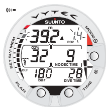
Fig. 3.24. Affichage de la pression partielle d'oxygène et de l'indicateur OLF. Une alarme sonore retentit quand la pression partielle est supérieure à 1.4 bar ou à la valeur choisie, l'indicateur OLF a atteint 80%.
