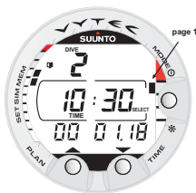
Fig. 4.7. Carnet de plongée, page I. Défilement des différentes pages d'une plongée.
