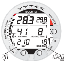
Fig. 3.9. Affichage en plongée. La pression d'air est de 210 bar et le temps d'autonomie en air est de 41 minutes. En appuyant sur le bouton TIME, l'heure et la température s'affichent pendant 5 secondes.
