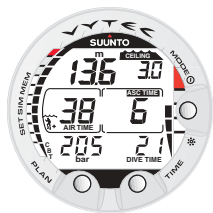
Fig. 3.17. Plongée avec paliers de décompression au-dessus de la profondeur plancher. La flèche a disparu et la mention ASC TIME ne clignote plus. Vous êtes dans la zone de décompression.
