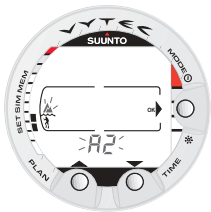
Fig. 4.23. Réglage d'altitude. Appuyez sur les boutons de défilement pour changer la zone d'altitude.
