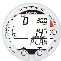
Fig. 3.6. Mode Planning. Le planning est signalé par l'abréviation PLAN. Le temps de plongée sans palier de décompression à 30.0 m est de 14 minutes en mode A0/P1.
