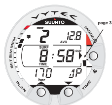
Fig. 4.9. Carnet de plongée, page III. Intervalle surface, profondeur moyenne et consommation en air indiqué par P.
