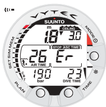
Fig.3.19. Plongée avec paliers de décompression, au-dessus de la profondeur plafond. La flèche vers le bas et la mention Er apparaissent. L'alarme sonore se déclenche également. Vous devez immédiatement redescendre (dans les 3 minutes) à la profondeur plafond ou plus bas.
