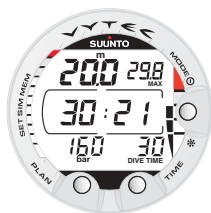
Fig. 3.28. plongée en Mode Gauge. Le temps d'immersion est 30 minutes 21 seconds.
