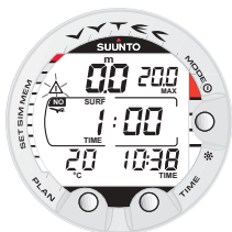
Fig. 3.30. Intervalle surface, heure. En appuyant sur le bouton TIME vous obtenez l'affichage Mode Surface.
