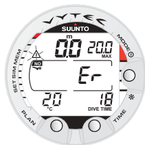
Fig. 3.32. Affichage surface après le non-respect d'une procédure de décompression. L'abréviation Er indique que la profondeur-plafond a été dépassée pendant plus de trois minutes. Vous ne devez plus plonger pendant au moins 48 heures.
