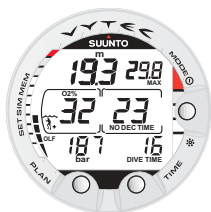
Fig. 3.22. Plongée nitrox. L'O2% est réglé à 32%.
