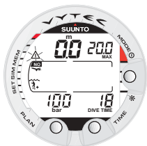
Fig. 3.29. Affichage en surface. Vous avez fait surface après une immersion de 18 minutes à la profondeur maximale de 20.0 m. La profondeur instantanée est de 0.0 m. Le voyant en forme d'avion vous indique l'interdiction de vol et le voyant attention que vous devez prolonger votre intervalle surface.
