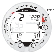
Fig. 4.8. Carnet de plongée, page II. Paramètres principaux de la plongée.
