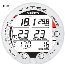
Fig. 3.26. L'OTU atteint la limite de toxicité. Le segment inférieur clignote et une alarme sonore retentit.
