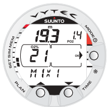
Fig. 3.27. Changer le mélange. Le mélange actuel est le MIX 1 (21%). Faire défiler les autres en appuyant sur le bouton PLAN ou TIME. Sélectionner en appuyant sur le bouton MODE (OK).
