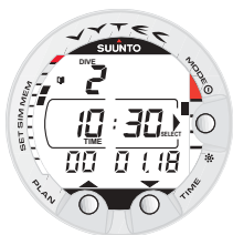
Fig.4.11. Carnet de plongée, page 1. Appuyez sur le bouton "CLÉ" SELECT, pour faire défiler les autres plongées.
