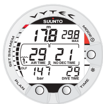
Fig. 3.23. Plongée nitrox. Lorsque l'autonomie en air est inférieure à 30 minutes, elle s'affiche en lieu et place de l'O2%.
