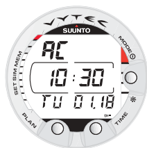
Kuva 2.4. AC -teksti on merkinä aktiivisista vesikontakteista.
