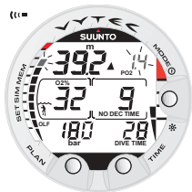
Kuva 3.24. Hapen osapaineen ja happikertymän (OLF) näytöt. Kuuluu äänihälytys, kun hapen osapaine ylittää arvon 1,4 bar tai asetetun arvon ja/tai OLF on saavuttanut 80% rajan.
