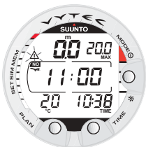
Kuva 3.31. Sukellusten välinen pinta-aika, lentokieltoaika. Painamalla TIME-painiketta kahdesti saat näytölle lentokieltoajan, jonka merkinä on lentokonesymboli.
