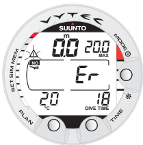
Kuva 3.32. Pintatila laiminlyödyn etapisukelluksen jälkeen. Er-symboli osoittaa, että olet laiminlyönyt kattsosyvyden yli kolmen minuutin ajan. Sinun tulee välttää sukeltamista ainakin 48 tunnin ajan.
