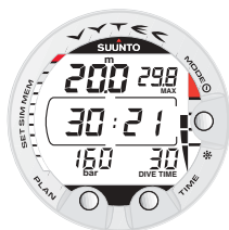
Kuva 3.28. Sukellusmittaritulassa. Tämänhetkinen sukellusaika on 30 minuuttia 21 sekuntia.
