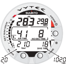
Kuva 3.9. Sukellusnäyttö. Tämänhetkinen säiliöpaine on 210 bar, ja jäljellä oleva ilma-aika on 41 minuuttia. Nykyisen kellonajan ja lämpötilan vuorotteleva näyttö näytetään 5 sekunnin ajan sen jälkeen, kun TIME -painiketta on painettu.
