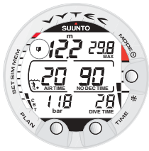
Kuva 3.10. Sukeltajan oman merkinnän aktivointi. Merkintä sijoitetaan profiilimui- stiin sukelluksen aikana painamalla PLAN -pai- niketta. Huomaa lokikirjasymboli.
