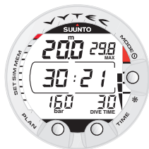
Abb. 3.28. Tauchen im Tiefenmesser-Modus. Die aktuelle Tauchzeit beträgt 30 Minuten und 21 Sekunden.
