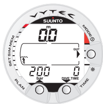
Abb. 4.18. Tauchsimulation eines ausgewählten Tauchgangs. Abtauchen durch Drücken des TIME-Kontaktes, Auftauchen durch Drücken des PLAN-Kontaktes.
