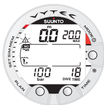
Abb. 3.29. Anzeige im Oberflächenmodus. Sie haben einen 18-minütigen Tauchgang durchgeführt, dessen maximale Tiefe 20,0m [66ft] betrug. Ihre aktuelle Tiefe ist 0,0m [0ft]. Das Flugverbots-Symbol zeigt, dass Sie nicht fliegen sollten und das ACHTUNG-Symbol weist Sie darauf hin, dass Sie Ihre Oberflächenpause wegen des Auftretens von Mikrobläschen verlängern sollten.
