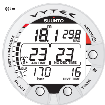
Abb. 3.26. Der Wert OTU\% überschreitet den CNS-Wert. Das unterste Segment beginnt zu blinken und ein akustischer Alarm ertönt.
