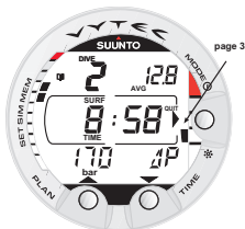
Abb. 4.9. Logbuch, Seite III. Oberflächenintervall, durchschnittliche Tiefe und Luftverbrauch, angezeigt durch \Delta P .
