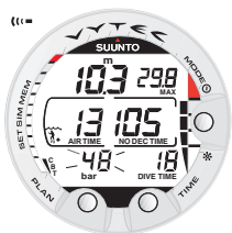
Abb. 3.12. Warnungen für den Flaschendruck. Der Flaschendruck ist unter 50bar gefallen, und es ertönt ein akustischer Alarm.
