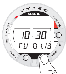
Abb.2.1. Zeitanzeige. Aktivierung durch Drücken von PLAN oder TIME.
