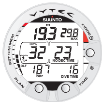
Abb. 3.22. Tauchen im Nitrox-Modus. O_2\% ist auf 32% eingestellt.
