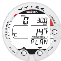
Abb. 3.6 Tauchgangsplanung. Der Planungsmodus wird durch den Text PLAN angezeigt. Die Nullzeitgrenze bei 30.0 [100 Fuss] Metern beträgt 14 Minuten im A0/P1-Modus.
