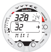
Abb. 4.28. Einstellen des ersten Gasgemisches (MIX 1). Der Sauerstoffgehalt liegt bei 32%, der Sauerstoffpartialdruck beträgt 1.4 bar. Die berechnete maximale Tiefe beträgt 32.8 m [107 Fuss]. Drücken Sie TIME oder PLAN, um den Sauerstoffprozentatz und die Partialdruckgrenze zu ändern. Bestätigen Sie die Einstellungen durch Drücken des MODE Kontakts (OK).
