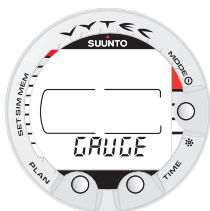
Abb. 3.3. Startup III. Oberflächenmodus. Tiefe und Tauchzeit sind Null, der Flaschendruck beträgt 300 bar [4350 psi]. Durch Betätigen des TIME Kontakts können Sie die Anzeige von Temperatur und aktueller Uhrzeit aktivieren.
