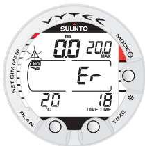
Abb. 3.32. Oberflächenmodus nach Nichtbeachten einer Dekompressionsstufe. Das "Er"-Symbol wird gezeigt, weil Sie eine Dekompressionsstufe länger als 3 Minuten nicht beachtet haben. Sie dürfen innerhalb der nächsten 48 Stunden nicht fliegen.
