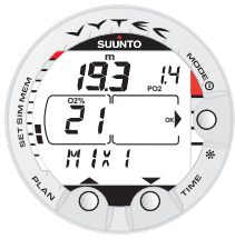
Abb.3.27. Wechsel des Gasgemisches. Das aktuelle Gasgemisch ist MIX 1 (21%). Blättern Sie durch die aktivierten Gasgemische durch Drücken der PLAN und TIME-Kontakte. Wählen Sie das neue Gemisch durch Drücken des MODE (OK)-Kontaktes.
