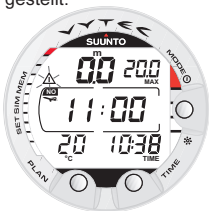
Abb. 3.31. Oberflächenintervall, Flugwarnung. Ein zweimaliges Drücken des TIME-Kontaktes zeigt die Zeit bis zum Ablauf der Flugverbotszeit, symbolisiert durch ein Flugzeug, an.
