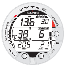
Abb. 3.17. Dekompressionstauchgang oberhalb der Dekompressionsgrenze. Der aufwärts gerichtete Pfeil ist verschwunden und ASC TIME blinkt nicht mehr, d.h. Sie befinden sich nicht mehr im Dekompressionsbereich.
