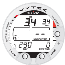
Abb. 3.7. Der Tauchgang hat gerade begonnen. Die Restluftzeit wird noch nicht angezeigt. Die erste Hochrechnung der Restluftzeit wird nach 30 bis 60 Sekunden angezeigt.
