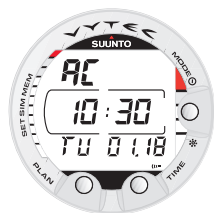
Abb. 2.4. Die Aktivierung der Wasserkontakte wird durch den Text "AC" dargestellt.
