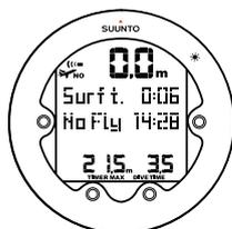
O tempo de inibição de voo é sempre, no mínimo, de 12 horas e equivale ao tempo de dessaturação quando este é superior a 12 horas. Para tempos de dessaturação inferiores a 70 minutos, o tempo de inibição de voo não é apresentado.
