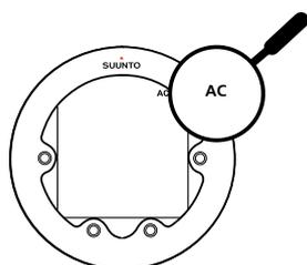
O ícone **AC** (AC) é apresentado até o contacto com a água ser desativado. É importante manter a área do contacto com a água limpa. A poluição ou sujidade pode impedir a ativação/desativação automáticas.
