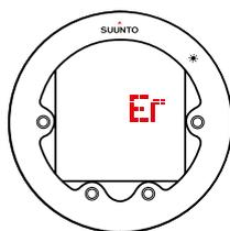
O algoritmo RGBM fica bloqueado por 48 horas se omitir as paragens de descompressão por mais de três (3) minutos. Quando o algoritmo é bloqueado, não existe informação disponível sobre o algoritmo e aparece mensagem **ER** (Er). Bloquear o algoritmo constitui uma função de segurança, realçando que a informação sobre o algoritmo já não se encontra válida.
