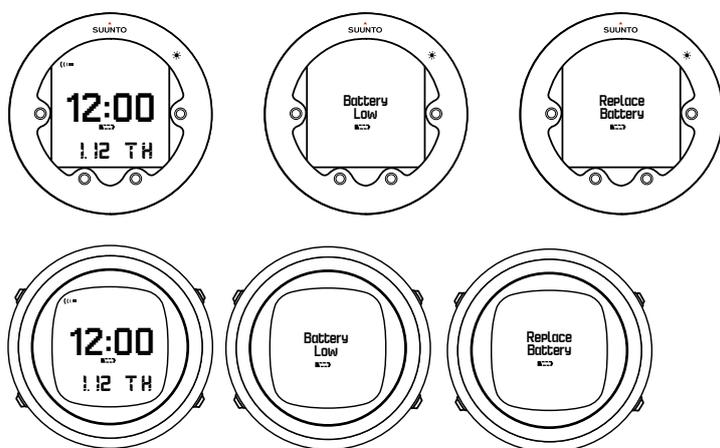
Se o ícone de bateria fraca aparecer no modo de superfície, ou se o ecrã estiver esbatido, a bateria poderá estar muito fraca. Recomenda-se a substituição da bateria.
