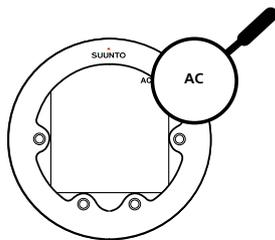
Aparece **AC** (AC) hasta que se desactive el contacto con el agua. Es importante mantener limpia el área de contacto con el agua. La suciedad o contaminación pueden impedir la activación/desactivación automática.
