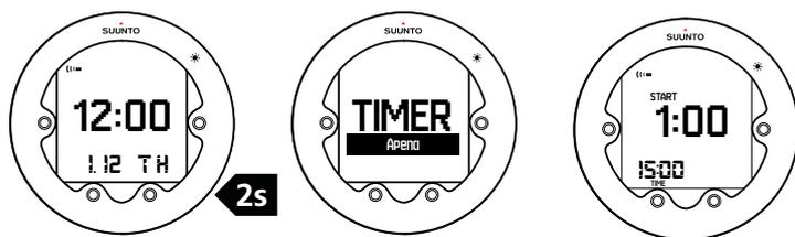
2. Mantén pulsado [DOWN] para introducir los ajustes del temporizador de apnea.
