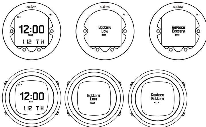
Si aparece el icono de batería baja en modo de superficie, o si la pantalla aparece descolorida, es posible que el nivel de la batería sea demasiado bajo. Se recomienda sustituir la batería.
