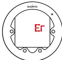
Si no realizas paradas de descompresión durante más de tres (3) minutos, el algoritmo RGBM se bloquea durante 48 horas. Cuando el algoritmo está bloqueado, no hay información disponible sobre el algoritmo y en su lugar aparece **ER** (Er). Bloquear el algoritmo es una medida de seguridad, que destaca que la información del algoritmo ya no es válida.
