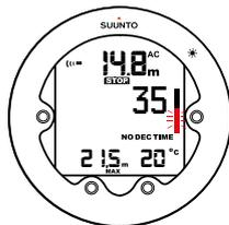
Las infracciones continuas en la tasa de ascenso tienen como resultado paradas de seguridad obligatorias. Ver 3.21. *Paradas de seguridad y paradas profundas.*
