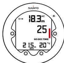
Wenn die maximale Aufstiegsgeschwindigkeit überschritten wird, beginnt das untere Segment des Balkens zu blinken und das obere Segment leuchtet durchgehend.
