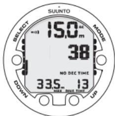
El cambio en su consumo de aire se basa en mediciones de presión constantes a intervalos de un segundo durante periodos de 30 - 60 segundos. Un aumento en el consumo de aire influirá rápidamente en el tiempo de aire restante, mientras que una bajada del consumo de aire aumentará lentamente el tiempo de aire. De esta forma, se evita una estimación de tiempo de aire demasiado optimista, causada por una bajada temporal en el consumo de aire.
