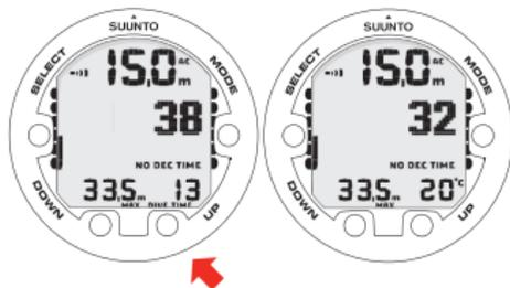
EL BOTÓN UP PERMITE CAMBIAR ENTRE EL TIEMPO DE INMERSIÓN Y LA TEMPERATURA DEL AGUA.
