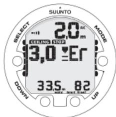
INMERSIÓN DE DESCOMPRESIÓN, POR ENCIMA DEL TECHO. OBSERVE LA FLECHA HACIA ABAJO, LA ADVERTENCIA "ER" Y LA ALARMA. DEBE DESCENDER INMEDIATAMENTE (EN LOS 3 MINUTOS SIGUIENTES) HASTA EL TECHO O POR DEBAJO DE ÉL.
