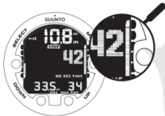
LA ACTIVACIÓN DE LA ILUMINACIÓN, LA ALARMA Y EL PARPADEO DE LA BARRA GRÁFICA DE VELOCIDAD DE ASCENSO INDICAN QUE ESTÁ ASCIENDEANDO A UNA VELOCIDAD SUPERIOR A LOS 10 m/min. SE RECOMIENDA QUE HAGA UNA PARADA DE SEGURIDAD OBLIGATORIA AL LLEGAR A UNA PROFUNDIDAD DE 6 m.
