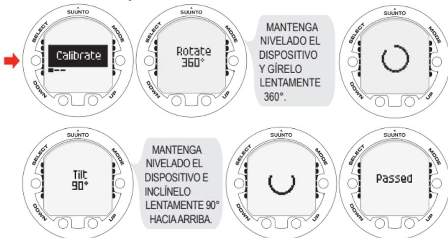
Si la calibración falla varias veces seguidas, es posible que se encuentre en una zona con fuentes de magnetismo, como objetos metálicos de gran tamaño, líneas eléctricas o aparatos eléctricos. Desplácese hasta otro lugar y vuelva a intentar la calibración de la brújula. Si la calibración sigue fallando, póngase en contacto con un centro de servicio técnico autorizado de Suunto.
