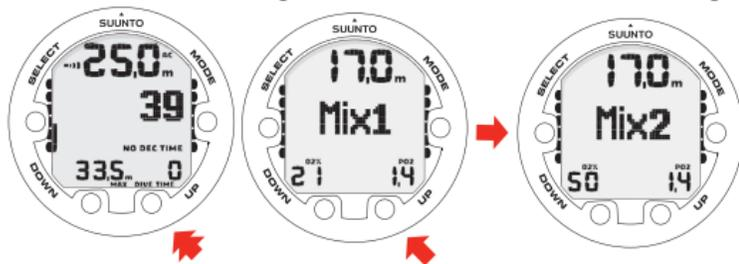
CAMBIO DE MEZCLA DE GASES. PARA CAMBIAR ENTRE LAS MEZCLAS ACTIVADAS, PRESIONE LOS BOTONES UP O DOWN. PARA SELECCIONAR UNA NUEVA MEZCLA, PRESIONE EL BOTÓN SELECT.
