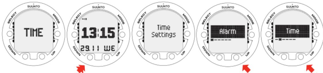
USE UP AND DOWN BUTTONS TO TOGGLE BETWEEN ALARM, TIME, DATE, UNITS, BACKLIGHT AND TONES.
