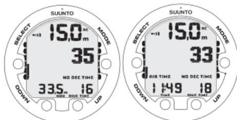
DOWN BUTTON TOGGLES BETWEEN MAXIMUM DEPTH, CURRENT TIME AND TANK PRESSURE.
