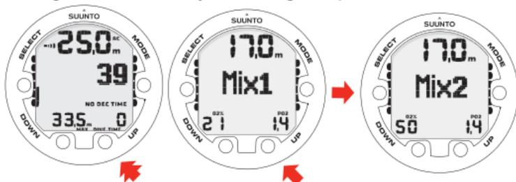
CHANGING GAS MIX. SCROLL THROUGH ENABLED MIXES BY PRESSING THE UP OR DOWN BUTTONS. SELECT NEW MIX BY PRESSING THE SELECT BUTTON.
