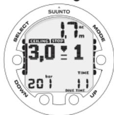
BEI ANZEIGE VON CEILING UND STOP SOFORT (INNERHALB VON 3 MINUTEN) MINDESTENS AUF TIEFE DER DEKOSTUFE ABTAUCHEN.
