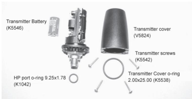
Teile des Drucksenders. Der Code bezeichnet die Ersatzteilnummer.
