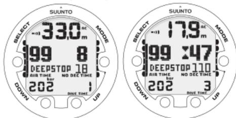
ES WIRD EMPFOHLEN, AUF EINER TIEFE VON 18 M EINEN DEEP STOP EINZULEGEN. DIE ZWEITE ANZEIGE ZEIGT, DASS DER DEEP STOP NOCH 110 SEKUNDEN DAUERT.
