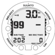
DER TAUCHGANG WURDE GERADE BEGONNEN UND DIE NULLZEIT LIEGT ÜBER 99 MINUTEN, ES WIRD KEIN WERT ANGEZEIGT.
