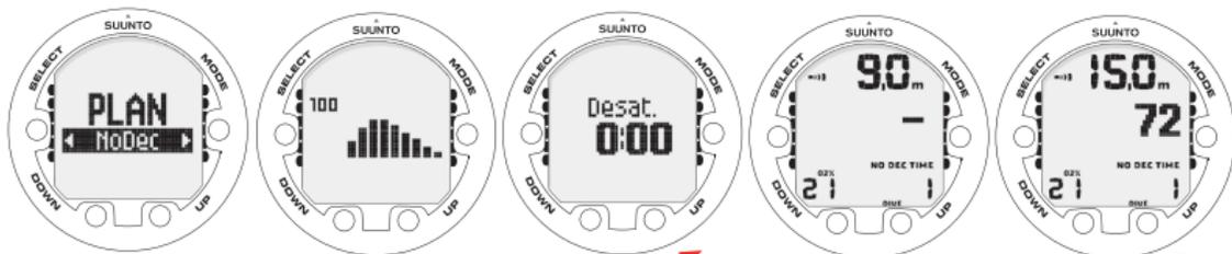
BEIM AUFRUFEN DES MODUS PLANNODEC WERDEN ZUNÄCHST KURZ GEWEBESÄTTIGUNG UND RESTENTSÄTTIGUNGSZEIT ANGEZEIGT, BEVOR DER PLANUNGSMODUS STARTET. VERSCHIEDENE NULLZEITGRENZEN MIT UP/DOWN-TASTEN WÄHLEN. NULLZEITEN ÜBER 99 MINUTEN WERDEN ALS „-“ ANGEZEIGT.
