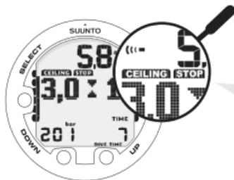
BEI ANZEIGE VON CEILING UND STOP VERBINDLICHEN SICHERHEITSSTOPP IN DER DEKOZONE ZWISCHEN 6 M UND 3 M EINLEGEN.
