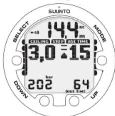
NACH OBEN WEISENDER PFEIL, BLINKENDE ANZEIGE ASC TIME UND ALARMTON WEISEN SIE AUF DEN AUFSTIEG HIN. DIE MINDESTAUFSTIEGSDAUER EINSCHLIESSLICH SICHERHEITSTOPP IST 15 MINUTEN. DIE DEKOSTUFE LIEGT AUF 3 M.
