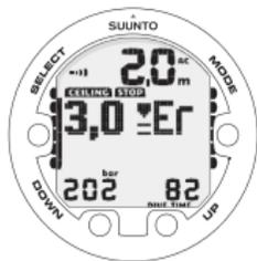
DEKOMPRESSIONSTAUCHGANG, ÜBER DEKOSTUFE. ACHTEN SIE AUF DEN NACH UNTEN WEISENDEN PFEIL, DIE WARNANZEIGE „ER“ UND DEN ALARM. SIE SOLLTEN SOFORT (INNERHALB VON 3 MINUTEN) MINDESTENS AUF DIE TIEFE DER DEKOSTUFE ABTAUCHEN.
