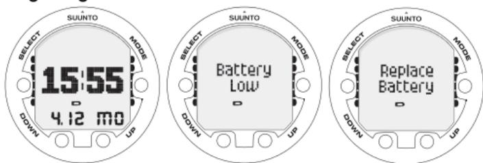
Bei Anzeige des Batteriesymbols im Oberflächenmodus oder bei schwachem Kontrast der Anzeige kann die Batterie zu stark entladen sein, um den Tauchcomputer zu betreiben. Es wird empfohlen, die Batterie zu wechseln.
