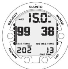
TAUCHANZEIGE – AKTUELLE TIEFE IST 15 M, KEIN DEKOMPRESSIONSSTOPP, ZEITLIMIT IST 38 MINUTEN, VERSTRICHENE TAUCHZEIT 13 MIN. DIE RESTLUFTZEIT BETRÄGT 99 MINUTEN, DER FLASCHENDRUCK 202 BAR.
