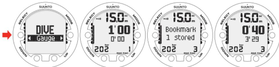
DRÜCKEN DER TASTE SELECT WÄHREND EINES TAUCHGANGS ERSTELLT EIN LESEZEICHEN IM PROFILSPEICHER. DIE ANZEIGE DER TAUCHZEIT WIRD ZURÜCKGESETZT UND DAS BISHERIGE INTERVALL WIRD UNTEN ANGEZEIGT.
