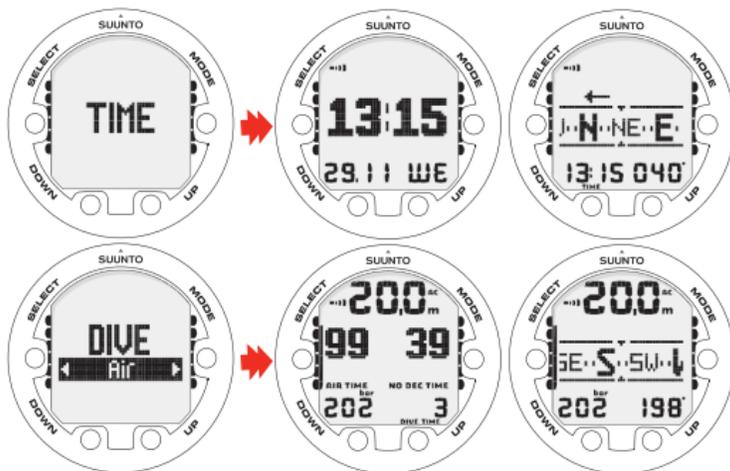
BEI ZUGRIFF AUS DEM TIME-MODUS WERDEN UHRZEIT UND RICHTUNG UNTEN IN DER ANZEIGE DARGESTELLT.
