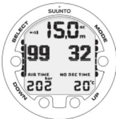
UP-TASTE WECHSELT ZWISCHEN ANZEIGE VON TAUCHZEIT UND WASSERTEMPERATUR.
