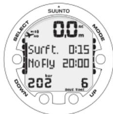
SIE HABEN EINEN TAUCHGANG VON 6 MIN GEMACHT UND SIND SEIT 15 MIN WIEDER AN DER OBERFLÄCHE. IHRE AKTUELLE TIEFE IST 0,0 M. DAS FLUGZEUGSYMBOL UND DIE ANGEZEIGTE FLUGVERBOTSZEIT WEISEN DARAUFG, DASS SIE IN DEN NÄCHSTEN 20 STUNDEN NICHT FLIEGEN SOLLTEN.
