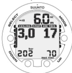
DER NACH OBEN WEISENDE PFEIL IST ERLOSCHEN UND DIE ANZEIGE ASC TIME HAT AUFGEHÖRT ZU BLINKEN. DIES BEDEUTET, DASS SIE DEN DEKOMPRESSIOBEREICH ERREICHT HABEN.
