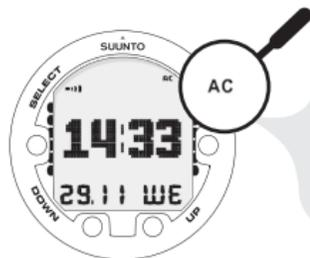
IN DER OBEREN RECHTEN ECKE DER ANZEIGE WIRD AC ANGEZEIGT, WENN DER TAUCHCOMPUTER MIT WASSER IN BERÜHRUNG IST. DIES AKTIVIERT AUCH DEN DIVE-MODUS.
