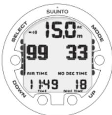
DOWN-TASTE WECHSELT ZWISCHEN ANZEIGE VON MAXIMALTIEFE, AKTUELLER TIEFE UND FLASCHENDRUCK.
