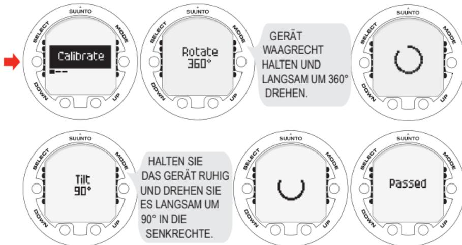
Falls die Kalibrierung mehrmals hintereinander fehlschlägt, befinden Sie sich möglicherweise in der Nähe einer Magnetquelle (z. B. größere Metallgegenstände, elektrische Leitungen oder Elektrogeräte). Ändern Sie Ihre Position und versuchen Sie erneut, den Kompass zu kalibrieren. Falls die Kalibrierung auch nach wiederholten Versuchen nicht gelingt, wenden Sie sich bitte an ein autorisiertes Suunto-Kundendienstcenter.
