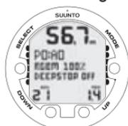
ACTIVACIÓN DEL MODO DE INMERSIÓN DE NITROX. LA PROFUNDIDAD OPERATIVA MÁXIMA, BASADA EN LOS AJUSTES DE O<sub>2</sub>% (21%) Y PO<sub>2</sub> (1,4 BARES) ES DE 56,7 m.
