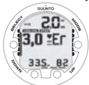
INMERSIÓN DE DESCOMPRESIÓN, POR ENCIMA DEL TECHO. OBSERVE LA FLECHA HACIA ABAJO, LA ADVERTENCIA "ER" Y LA ALARMA. DEBE DESCENDER INMEDIATAMENTE (EN LOS 3 MINUTOS SIGUIENTES) HASTA EL TECHO O POR DEBAJO DE ÉL.
