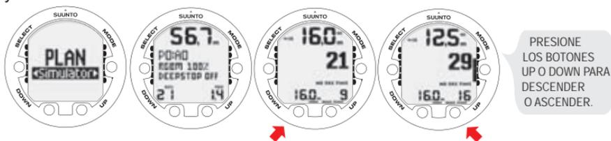
Este modo también puede usarse para añadir los intervalos en superficie deseados a las simulaciones de inmersión. Añada los incrementos de intervalo en superficie deseados al intervalo en superficie actual presionando los botones UP y DOWN.
