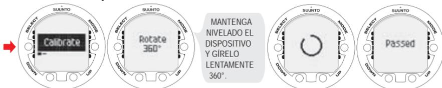
Si la calibración falla varias veces seguidas, es posible que se encuentre en una zona con fuentes de magnetismo, como objetos metálicos de gran tamaño, líneas eléctricas o aparatos eléctricos. Deplácese hasta otro lugar y vuelva a intentar la calibración de la brújula. Si la calibración sigue fallando, póngase en contacto con un centro de servicio técnico autorizado de Suunto.
