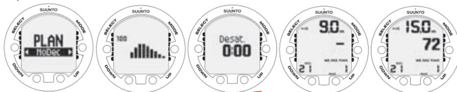
AL ENTRAR EN EL MODO MEMPLAN, LA PANTALLA MUESTRA BREVEMENTE LA CARGA DE LOS TEJIDOS, EL TIEMPO DE DESATURACIÓN RESTANTE ANTES DE ENTRAR EN EL MODO PLAN. UTILICE LOS BOTONES UP Y DOWN PARA VER LOS DISTINTOS LÍMITES SIN DESCOMPRESIÓN. LOS LÍMITES SIN DESCOMPRESIÓN SUPERIORES A LOS 99 MINUTOS SE REPRESENTAN CON "--".
