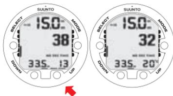
EL BOTÓN UP PERMITE CAMBIAR ENTRE EL TIEMPO DE INMERSIÓN Y LA TEMPERATURA DEL AGUA.
