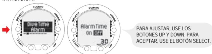
**NOTA** *Dentro de un rango de 1 a 999 minutos, puede ajustar la alarma, por ejemplo, a su tiempo de inmersión previsto.*
