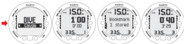
AL PRESIONAR EL BOTÓN SELECT DURANTE UNA INMERSIÓN, SE GUARDA UN MARCADOR EN LA MEMORIA DEL PERFIL, EL TEMPORIZADOR DE INMERSIÓN SE PONE A CERO Y EL INTERVALO CRONOMETRADO ANTERIORMENTE SE MUESTRA EN LA PARTE INFERIOR.
