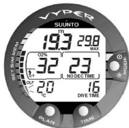
Figuur 6.14. De laagste staaf knippert om aan te geven dat de OLF-waarde betrekking heeft op OTU.
