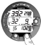
Figuur 6.13. Alternatief venster. Na een druk op de knop TIME worden de huidige tijd, maximale diepte en CBT weergegeven.
