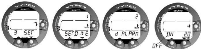
Figuur 5.2. Duiktijdalarm instellen. Druk op de bladerknoppen om een alarm in of uit te schakelen en de duiktijd in te stellen.
