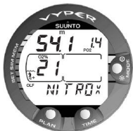
Figuur 6.11. Venster voor Nitrox. Maximale diepte op basis van ingesteld O 2 % (21%) en PO 2 (1,4 bar) is 54,1 meter.
