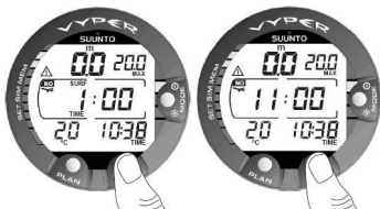
Figuur 7.2. Weergave van oppervlakte-interval, oppervlaktetijd en duur van vliegverbod: druk één keer op de knop TIME om de oppervlaktetijd weer te geven en twee keer voor de duur van het vliegverbod die wordt aangegeven door het vliegtuigsymbool.
