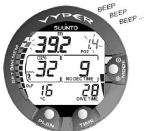
Figuur 6.12. Weergave van partiële zuurstofdruk en OLF. Er klinkt een geluidssignaal als de partiële zuurstofdruk groter is dan 1,4 bar of de ingestelde waarde en/of de OLF-waarde de limiet van 80% heeft bereikt.
