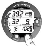
Figura 6.13. Pantalla alternativa. Al pulsar el botón TIME se muestran la hora actual, la profundidad máxima y el tiempo de fondo.
