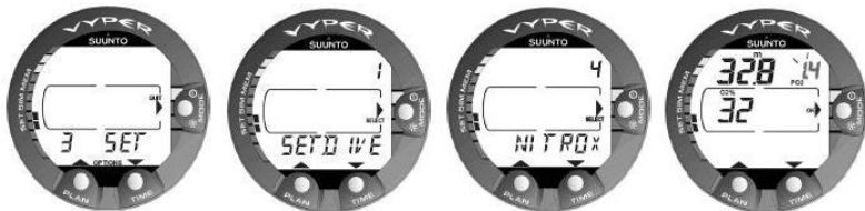
Figura 5.4. Ajuste de porcentaje de oxígeno y presión parcial. La profundidad máxima equivalente se muestra como 32,8 m/107 pies. Presione los botones de desplazamiento para modificar el porcentaje de oxígeno y para ajustar el valor de ajuste parcial de oxígeno.
