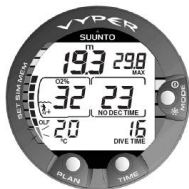
Figura 6.14. El gráfico de barras inferior parpadea para indicar que el valor de FLO mostrado está relacionado con el valor de UTO.
