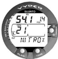
Figura 6.11. Pantalla de nitrox. La profundidad máxima, basada en los ajustes de O_2\% (21%) y PO_2 (1,4 bares) es de 54,1 m/177 pies.
