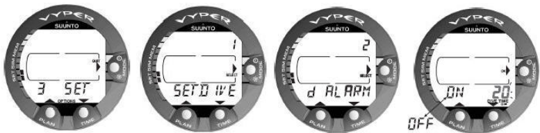
Figura 5.2. Ajuste de alarma de tiempo de inmersión. Presione los botones de desplazamiento para activar o desactivar la alarma y para ajustar el valor de tiempo de inmersión.
