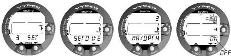
Figura 5.3. Ajuste de alarma de profundidad máxima. Presione los botones de desplazamiento para activar o desactivar la alarma y para ajustar el valor de profundidad máxima.
