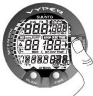
Figura 5.5. Inicio I. Todos los segmentos mostrados.
