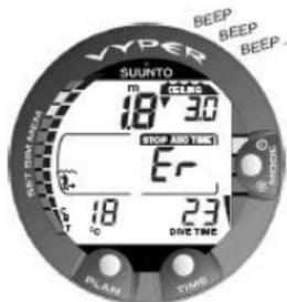
Abbildung 6.10. Dekompressionstauchgang, über Dekostufe. Beachten Sie den nach unten weisenden Pfeil, eine Fehlerwarnung „Er“ und einen Warnton. Sie sollten sofort (innerhalb von 3 Minuten) mindestens auf die Tiefe der Dekostufe abtauchen.
