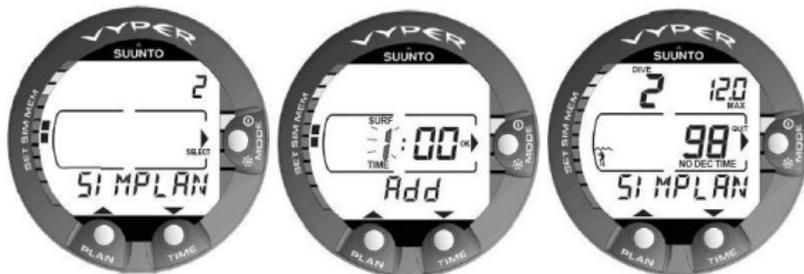
Abbildung 7.13. Planungssimulatormodus [2 SIMPLAN]. Geben Sie dazu einfach mit den Tasten TIME und PLAN die gewünschte Erhöhung des Oberflächenintervalls (zum aktuell angezeigten Oberflächenintervall) ein. Diese Anzeige wird nur bei wiederholten Tauchgängen angezeigt.
