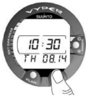
Abbildung 3.1. Zeitanzeige. Drücken Sie PLAN oder TIME, um das Display zu aktivieren.
