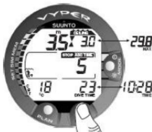
Abbildung 6.9. Dekompressionstauchgang, in Dekozone. Zwei gegeneinander gerichtete Pfeile („Sanduhr-Symbol“). Sie befinden sich in der Dekozone auf 3,5 m (11 ft) und Ihre Mindestaufstiegsdauer beträgt 5 Minuten. Durch das Drücken der Taste TIME werden die alternativen Anzeige aufgerufen.
