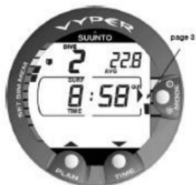
Abbildung 7.7. Logbuch, Seite III. Oberflächenintervall und durchschnittliche Tiefe.
