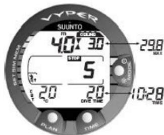
Abbildung 5.9. Ein verbindlicher Sicherheitsstopp. Es wird Ihnen empfohlen, einen verbindlichen Sicherheitsstopp in einer Tiefe zwischen 6 m und 3 m (20 ft und 10 ft) einzulegen. Drücken Sie die Taste TIME, um die alternative Anzeige anzuzeigen.
