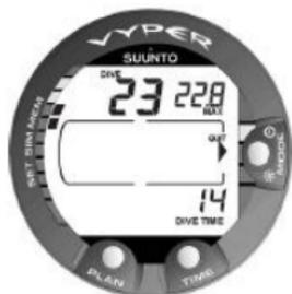
Abbildung 7.10. Tauchübersichtinformation Tauchgänge gesamt, Tauchzeit und maximale Tiefe.
