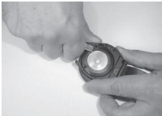
Abbildung 9.1. Öffnen des Sicherungsrings.
