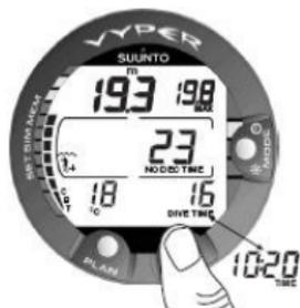
Abbildung 6.2. Tauchanzeige. Die aktuelle Tiefe beträgt 19,3 m (63 ft) und die Nullzeitgrenze beträgt im A0/P1-Modus 23 Minuten. Die maximale Tiefe des Tauchgangs war 19,8 m (65 ft.), die verstrichene Tauchzeit ist 16 Minuten. Die aktuelle Uhrzeit 10:20 (10:20 am) wird nach dem Drücken der Taste TIME für 5 Sekunden angezeigt.
