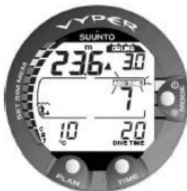
Abbildung 6.7. Dekompressionstauchgang, unterhalb der Dekogrenze. Nach oben weisender Pfeil, blinkende Anzeige ASC TIME und Alarmton weisen Sie auf den Aufstieg hin. Minimale Aufstiegszeit einschließlich Sicherheitsstopp ist 7 Minuten. Dekostufe ist bei 3 m (10 ft).
