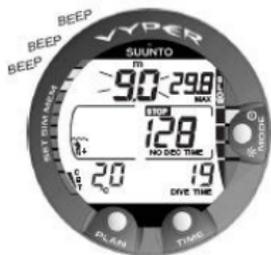
Abbildung 6.4. Anzeige der Aufstiegs geschwindigkeit. Blinkende Tiefenanzeige, SLOW und vier Segmente werden angezeigt: Die Aufstiegs geschwindigkeit beträgt mehr als 10 m/min (33 ft/min). Dies ist eine Warnung, dass Sie Ihren Aufstieg verlangsamen müssen! Das STOP-Zeichen bedeutet, dass Sie einen verbindlichen Sicherheitsstopp in einer Tiefe von 6 m (20 ft) einlegen sollten.
