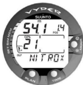
Abbildung 6.11. Nitrox-Ansicht. Die maximale Tauchtiefe basierend auf den eingestellten Werten für  $O_2$  (21 %) und  $PO_2$  (1,4 bar) liegt bei 54,1 m (177 ft).
