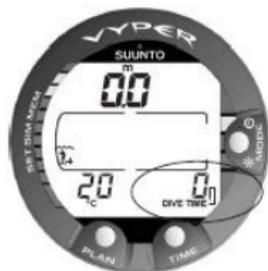
Abbildung 5.7. Batteriewarnung. Das Batteriesymbol zeigt an, dass die Batterieladung gering ist. Es wird empfohlen, die Batterie zu wechseln.
