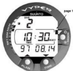
Abbildung 7.5. Logbuch, Seite I. Blättert durch verschiedene Seiten eines bestimmten Tauchgangs.
