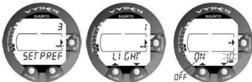
Abbildung 4.8. Einstellung der Beleuchtungsdauer. Drücken Sie die Pfeiltasten, um das Licht ein- oder auszuschalten und die Beleuchtungsdauer festzulegen.
