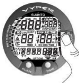
Abbildung 5.5. Start I. Alle Segmente werden angezeigt.
