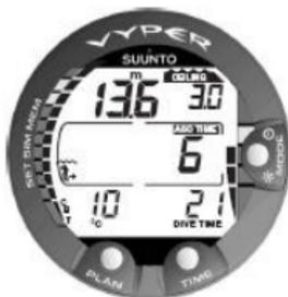
Abbildung 6.8. Dekompressionstauchgang, oberhalb der Dekogrenze. Der nach oben weisende Pfeil wurde ausgeblendet und die Anzeige ASC TIME hat aufgehört zu blinken. Dies bedeutet, dass Sie den Dekompressionsbereich erreicht haben.
