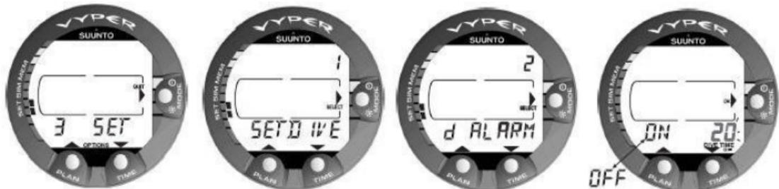
Abbildung 5.2. Einstellen des Tauchzeitalarms. Drücken Sie die Scrolltasten, um den Alarm aus- oder einzuschalten und den Tauchzeitwert einzustellen.
