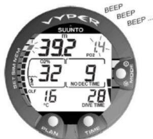
Abbildung 6.12. Anzeigen Sauerstoffpartialdruck und OLF. Ein akustischer Alarm wird ausgelöst, wenn der Sauerstoffpartialdrucks größer als 1,4 bar oder dem eingestellten Wert ist, und der OLF die 80 % Grenze erreicht hat.
