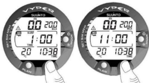
Abbildung 7.2. Anzeigen Oberflächenintervall, Oberflächenzeit und Flugverbotszeit: Nach einmaligem Drücken der TIME-Taste wird der Oberflächenintervall angezeigt, bei zweimaligem Drücken der TIME-Taste wird die Flugverbotszeit zusammen mit dem Flugzeug
