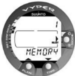
Abbildung 4.2. Mit den Pfeiltasten können Sie durch die Modusoptionen scrollen.
