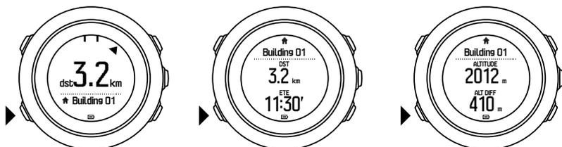
静止状態あるいは移動速度がゆっくりな場合 ( 4 km/h 未満 )、コンパスで測定された方位をもとに POI ( ルートナビゲーションを使用中の場合は中間地点 ) の方向が時計に表示されます。
