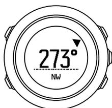
コンパスディスプレイに表示する情報は、一般設定 » 表示形式 » コンパス単位 の下にあるオプションメニューで変更できます。コンパスディスプレイの中央に表示する基本情報は、方角 ( 角度 )、Mil、または基本方位 ( 東西南北 ) のいずれかを選択することができます。
