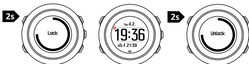
ボタンロック機能は、一般設定 » トーン/ディスプレイ » ボタンロック の下にある時計の設定で変更できます。
