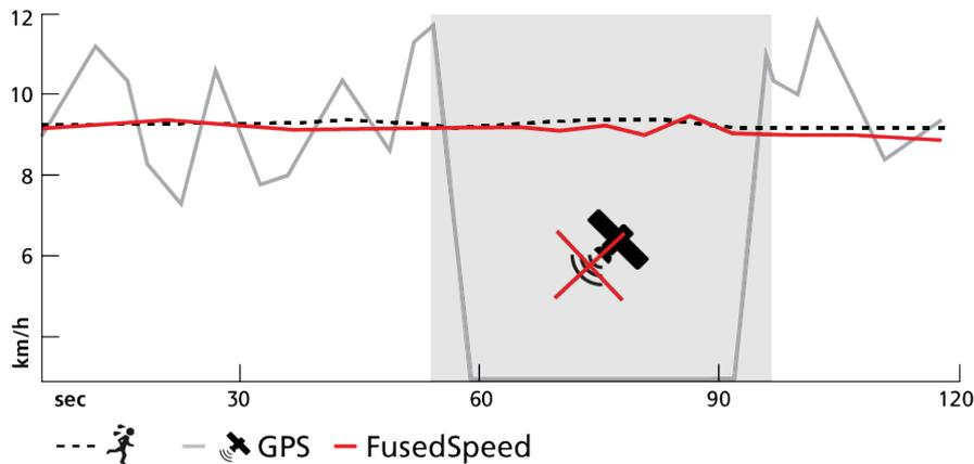
在您進行的訓練需要高度反應速度讀數時（例如在不平坦地面跑步或在間歇訓練期間），FusedSpeed 對您的幫助最大。舉例而言，如果暫時失去 GPS 訊號，在 GPS 校準加速計的協助下，Suunto Race 能夠繼續顯示精準的速度讀數。
