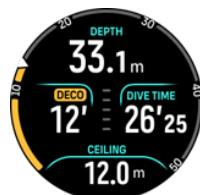
最終減圧深度は、アルゴリズム設定で 3.0 m または 6.0 m に設定できます（初期設定の深度は 3.0 m）。5.7.6. 最終減圧深度を参照してください。
