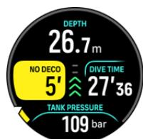
4. タンク圧アラームを設定できます。アラームを設定することで、ターンプレッシャー(折り返し地点での残圧)など重要な限界値を常に把握できます。アラームを設定すると、Suunto Ocean は 100 bar ( 1,450 psi ) に達した時点でアラートを表示します。
