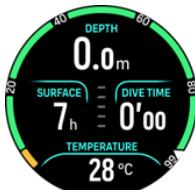
**減圧不要限界(NDL)**：ダイビングを開始すると、水面休息時間の表示場所に NDL 時間が表示されます。現在の深度における、減圧停止が必要になるまでの残り時間が分単位で表示されます。NDL 時間が 99 分を超える場合、「>99」と表示されます。NDL 時間が 5 分以下の場合、強制アラームが発動します。NDL 時間が 5 分を超えるか、減圧情報が表示されるまで、NDL 時間の表示場所が強調されます。強制アラームに関する詳細については、[5.4.1. 強制ダイブアラーム](#)を参照してください。
