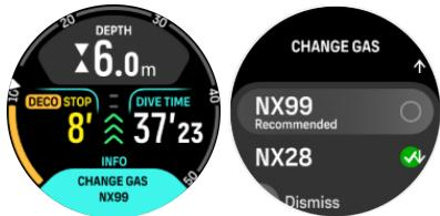
6. 最終停止深度に到達しました。減圧停止時間が消去されると、減圧バッジが消え、停止が安全停止に変わります。この例では、安全停止が調整済みに設定され、6 m での時間が長いため、カウントダウンが 1 分 30 秒から開始します。
