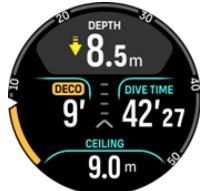
許容範囲を超えてさらに浮上した場合、この範囲内に戻るまで減圧計算は一時停止します。この場合アラーム音が鳴り、シーリング深度を示す数字の隣に赤色の下向き矢印が表示され、危険な減圧であることを警告します。アラームを無視し、許容範囲よりも浅い深度に3分間留まり続けると、減圧停止が実施されなかつたと判断され、アルゴリズム違反に関する通知が表示されます。
