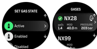
浮上時により適切なガスがある場合は、そのガスに切り替えるように通知されます。
