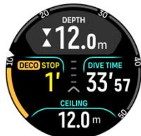
連続式浮上モードでの減圧停止では、シーリング深度近くに留まっている間は、シーリング深度が継続的に浅くなっています。これにより、最適な浮上時間での連続的な減圧が可能になります。
