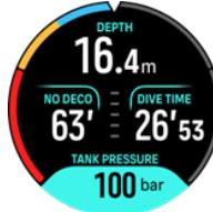
**メモ:** Suunto Tank POD にペアリングしていない場合、切り替えウィンドウのタンク圧には「TANK POD なし」と表示されます。Tank POD はペアリングされているがデータが受信されていない場合、「--」と表示されます。この場合、Tank POD が受信範囲内にはない、タンクが閉まっている、あるいは Tank POD のバッテリー残量が低い可能性があります。
