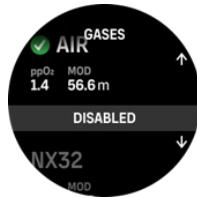
単一ガスモードでは、使用中のガスに設定できるのは 1 つのみです。新しいガスを作成する場合、使用中のガスに設定するか、必要な時に簡単に有効にできるよう頻繁に使用する混合ガス ( NX32 など ) として保存するかを選択できます。
