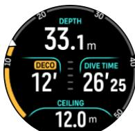
**停止時間**：ダイビング中に安全停止または減圧停止が必要になった場合、NDL または減圧情報の表示場所に停止タイマーが表示され、必須停止時間が分・秒単位でカウントダウンされます。停止深度の範囲が深度の表示場所に表示されます。停止が完了すると、「停止完了」が
