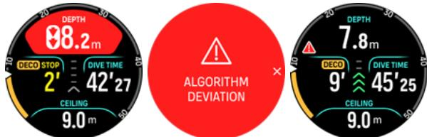
Suunto Ocean は、アルゴリズム違反を通知するアラートを解除すればロックされません。Suunto Ocean は減圧停止違反があった場合でも、元の減圧計画の表示を続けます。赤色の警告がウィンドウに表示され、必要な減圧停止が完了されるか48時間経過されるまで、ダイビングウィンドウにそのまま表示されます。
