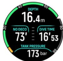
3. No deco が 5 分になると、黄色の注意アラームが作動します。浮上を開始し No deco 時間が長くなると、アラームは解除されます。また、いずれかのボタンを押すとアラームをミュートにできます。No deco アラームが作動したあとも深い深度での滞在を続けると減圧義務が発生します。十分な講習を受けていない場合、減圧潜水を行わないでください。
