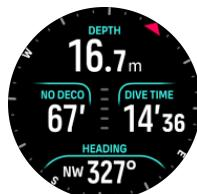
中央ボタンを長押しすると、目的地の方角を設定できます。方角を設定すると設定完了の通知が表示され、設定した進行方向を示す矢印がコンパスアーチに表示されます。方角が設定されると、目的地への方角を示す矢印はコンパスアーチ上に固定され、設定した進行方向を示します。矢印の反対側にはオレンジ色のスロットが表示され、反対の方角（180 度）を示します。
