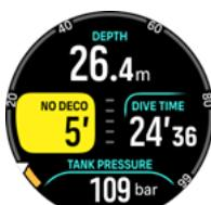
**減圧時間**：NDL 時間を超過した場合、アラームが発動し、NDL 時間の表示場所に最適な浮上時間 (TTS) が分単位で表示されます。Deco バッジが表示され、NDL アーチがオレンジ色に変わり同じ TTS 時間を表示します。切り替えウィンドウにはシーリング深度の値が表示されます。シーリング深度の値は、減圧停止を実施する深度を指しています。また、アラームが作動します。アラームはいずれかのボタンを押すことで解除できます。減圧潜水に関する詳細については、[5.8.2. 減圧潜水](#)を参照してください。
