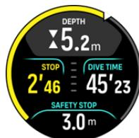
安全停止には、推奨安全停止と強制安全停止の 2 種類があります。ダイブ中に推奨された最大浮上速度を超過した場合、安全停止は強制となります。安全停止が強制となった場合、2.4 m より浅い深度まで浮上すると、赤色の矢印がウィンドウインジケータに表示されます。安全停止が強制ではない場合、黄色の矢印のみが使用されます。
