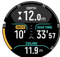
シーリング深度よりさらに浮上した場合でも、シーリング深度から 0.6 m ( 2 ft ) 以内であれば、許容範囲として安全に減圧することができます。このシーリング深度を超えた許容範囲内でも減圧計算は行われますが、シーリング深度よりも深い深度に潜降するようにしてください。深度の値の隣に黄色の下向き矢印が表示され、潜降するよう警告します。
