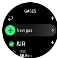
使用中のガスは削除できません。使用中のガスを切り替える場合、既存のガスを修正するか、新しいガスを作成しガス状況を使用中に設定する必要があります。使用中のガスを切り替えると、それまで使用していたガスは、単一ガスモードの場合は無効、マルチガスモードの場合は有効になります。
