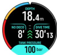
5. 浮上速度は浮上速度インジケータで確認できます。推奨される最大浮上速度の分速 10 m を超えると、インジケータが赤色になりアラーム音と振動によるアラームが作動します。いずれかのボタンを押すことで解除できます。
