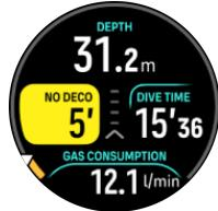
3. NDL が 0 になり、減圧が必要になりました。ゲージがオレンジ色に変わり減圧時間が表示されます。NDL が表示されていた場所には、減圧停止と安全停止を含んだ TTS が表示されます。また、シーリング深度が切り替えウィンドウに表示されます。
