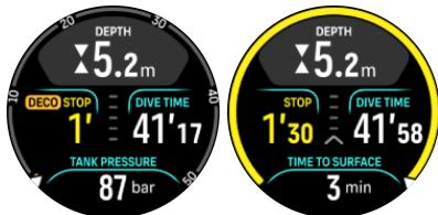
7. 減圧停止または安全停止の範囲より浅く浮上すると、矢印と警告が表示され範囲内に潜降するよう指示されます。
