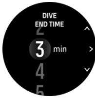
**メモ:** 水面に浮上した後、設定した終了時間内に再び潜水をした場合、*Suunto Ocean* はこれらを 1 回のダイビングとみなします。
