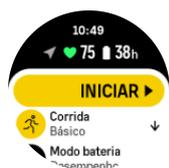
Há três modos de bateria predefinidos; **Desempenho** (predefinido), **Resistência** e **Viagem**. Se alternar entre estes modos, altera a duração da bateria, mas também altera o desempenho do dispositivo.
