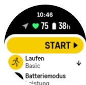
Du kannst zwischen drei voreingestellten Batteriemodi wählen: **Leistung** (Standard), **Ausdauer** und **Tour**. Durch den Wechsel zwischen diesen Modi ändert sich die Batterielaufzeit und im gleichen Maße auch die Leistung der Uhr.
