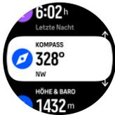
3. Die Kompassanzeige zeigt die aktuelle Höhe, den Luftdruck und deine Position in Bezug auf Magnetisch Nord an.
