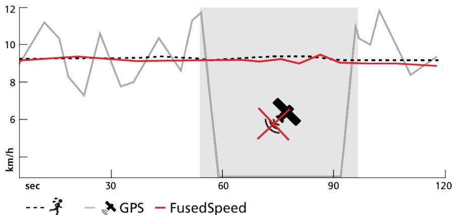
FusedSpeed ist besonders nützlich, wenn du beim Training sehr reaktionsfähige Geschwindigkeitsmessungen benötigst, zum Beispiel beim Laufen auf unebenem Gelände oder beim Intervalltraining. Wenn das GPS-Signal zeitweise abbricht, kann Suunto 9 Peak Pro mithilfe des GPS-kalibrierten Beschleunigungsmessers weiterhin genaue Geschwindigkeitsmesswerte liefern.
