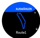
Tippe auf das Display oder halte die Mitteltaste gedrückt, um die detaillierte Ansicht zu vergrößern oder zu verkleinern. Du kannst die Vergrößerungsstufe mit der oberen oder unteren Taste anpassen.
