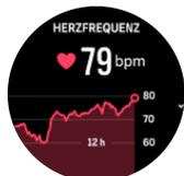
Im HF-Widget erhältst du einen Schnappschuss deiner Herzfrequenz und eine 12-Stunden-Grafik deiner Herzfrequenz. Die Grafik wird anhand deiner durchschnittlichen Herzfrequenz auf Basis von 24-minütigen Zeitfenstern erstellt.
