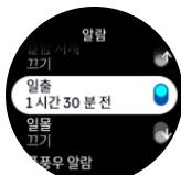
3. 상단 및 하단 버튼으로 위/아래로 스크롤하고 중간 버튼으로 확인해서 일출/일몰 전에 원하는 시간 및 분을 설정합니다.
