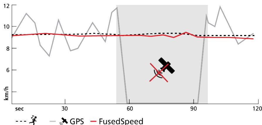
FusedSpeed는 고르지 않은 지형에서 달리는 등의 트레이닝이나 인터벌 트레이닝 중에 민감한 반응 속도 표시값이 필요한 경우 가장 유용합니다. 예를 들어 일시적으로 GPS 신호를 인식하지 못하는 경우, Suunto 9 Peak Pro는 GPS 교정 가속도계를 이용해 계속해서 정확한 속도 표시값을 표시할 수 있습니다.
