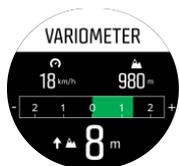
Im oberen Teil des Variometer Displays werden deine aktuelle horizontale Geschwindigkeit und die aktuelle, auf dem Meeresspiegel basierende Höhe angezeigt.
