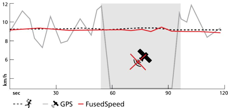
FusedSpeed può essere particolarmente utile quando serve grande reattività nella lettura della velocità durante l'allenamento, ad esempio quando si corre su terreni accidentati o durante l'allenamento intervallato. Se si perde temporaneamente il segnale GPS, ad esempio, Suunto 5 è in grado di continuare a fornire precisi dati di velocità grazie all'accelerometro calibrato GPS.
