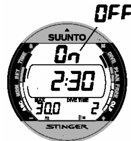
Fig. 4.13. Alarme de tempo de Mergulho. A janela central mostra menos de 5 minutos de tempo de mergulho.
