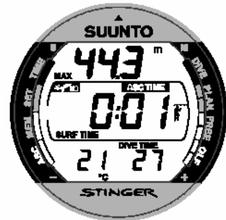
Fig. 3.26. Mostrador de Superfície após uma descompressão violada. O ícone ASC TIME indica que você violou a profundidade de teto por mais que 3 minutos. O mostrador alternativo indica que você não deve mergulhar por pelo menos 48 horas.
