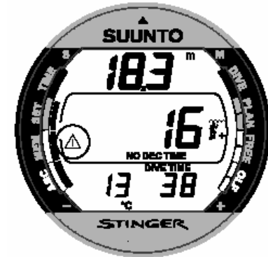
Fig. 3.7. Ativação do Marcador. Uma anotação é feita na memória do perfil durante o mergulho, pressionando o botão S .
