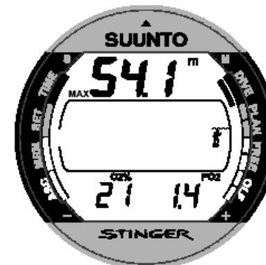
Fig. 3.21 Mostrador em Nitrox. Profundidade máxima baseada em 21 % O_2 e uma PO_2 de 1,4 bar, é de 54,1 metros (177 ft).
