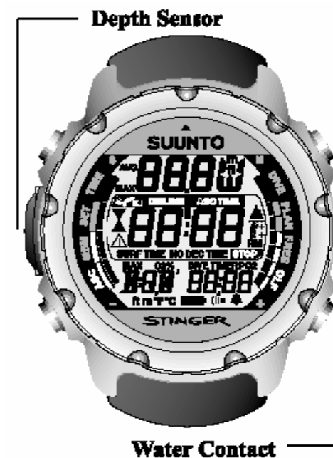
Fig. 2.2 Contatos e sensores de Profundidade
