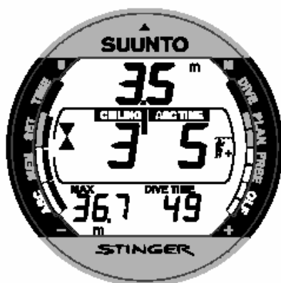
Fig. 3.19 Mergulho Descompressivo na zona de teto. Duas setas apontando uma para outra (ampulheta). Você está no melhor patamar de profundidade (3,5 m / 11 ft) e o seu tempo mínimo de subida é de 5 min.
