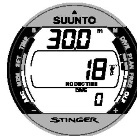
Fig. 3.9. Planejando. O limite não descompressivo a 30 m (100 ft) é de 18 min com P0/A0.
