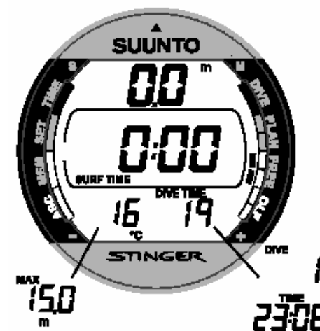
Fig. 3.34. Mostrador de Superfície após um mergulho em Modo Gauge. A janela central mostra o tempo de superfície
