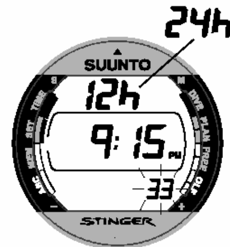
Fig. 4.3. O modo de ajuste de Hora é ativado e os dígitos dos segundos começam a piscar (Pág I)
