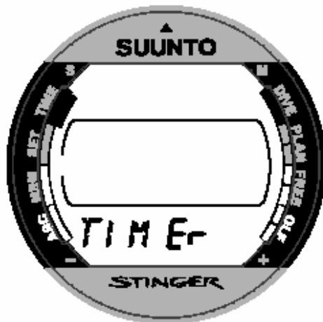
Fig. 2.6 A função de cronometro é indicada pelo texto TIMER e o indicador de modo
