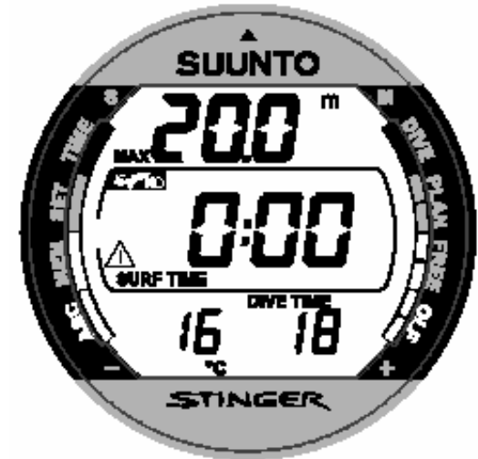
Fig. 3.24. Mostrador de Superfície. Você foi a superfície após um mergulho de 18 minutos com uma profundidade máxima de 20 metros. A profundidade atual é de 0 metros e o tempo de intervalo de superfície é de 0 minutos. O ícone do avião indica que você não deve voar, e o ícone de atenção ao mergulhador, sugere que você estenda o seu intervalo de superfície por causa do excesso de microbolhas.
