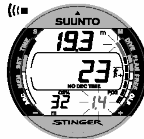
Fig. 3.23. O mostrador com a pressão parcial de Oxigênio e a OLF . Se a pressão parcial do Oxigênio é maior que 1,4 bar ou o valor estipulado, ou se a OLF chegou a um valor de 80 % do seu limite, o último segmento do gráfico de barras irá piscar, acompanhado de um aviso sonoro. Quando a OLF chegar a 100 %, todos os segmentos do gráfico de barras irão piscar. Se a OTU for maior que a CNS, o segmento inferior irá piscar.
