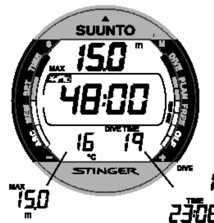
Fig. 3.35. Alterando o Mostrador de Superfície após um mergulho em Modo Gauge. A janela central mostra o tempo de espera para o voo
