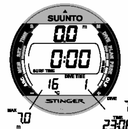
Fig. 3.32. Mostrador de Superfície após um mergulho Livre. A janela central mostra o tempo de superfície
