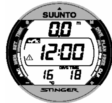
Fig. 3.25. Mostrador de Superfície. As informações alternativas incluem o tempo de espera para o vôo.
