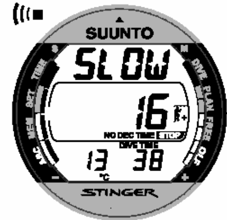
Fig. 3.15. Indicador de Velocidade de Subida. O texto SLOW e quatro segmentos da barra lateral são mostrados acompanhados de um sinal sonoro. A vel. de subida é maior que 10 m/min (33 ft/min). Esse é um aviso para se diminuir a velocidade de subida. O texto STOP sinaliza que uma parada de segurança obrigatória quando você chegar a uma profundidade de 6 m (29 ft).
