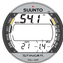
Fig. 4.9. Modifica dei dati Percentuale di Ossigeno e Pressione Parziale.
