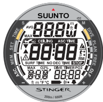
Fig. 3.2. Attivazione I. Sono visualizzati tutti i segmenti del display.
