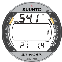
Fig. 3.21. Display Nitrox. La massima profondità ammissibile, calcolata in base alla % di O_2 (21%) ed alla PO_2 (1,4 bar), è m. 54,1 [177 ft].
