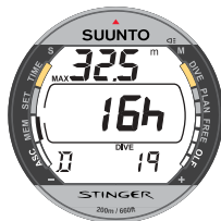
Fig. 5.9. Memoria Storica immersioni con autorespiratore. Numero totale di immersioni, ore di immersione e massima profondità raggiunta.
