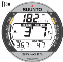
Fig. 3.17. Immersione con decompressione, più profondi di Floor. La freccia con la punta rivolta verso l'alto, la scritta ASC TIME lampeggiante ed un segnale acustico indicano che è opportuno risalire. Il tempo totale di risalita minimo, inclusa la sosta di sicurezza, è 7 minuti. Il Ceiling è a 3 m [10 ft].
