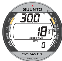
Fig. 3.9. Pianificazione. Il tempo di non decompressione a 30.0 m [100 ft] è 18 minuti in P0/A0.
