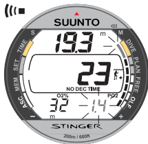
Fig. 3.23. Pressione parziale di Ossigeno e indicazione dello OLF. Se il valore di PO_2 supera 1,4 bar o il valore preimpostato, e/o l'OLF ha raggiunto il limite del 80% si attiva un allarme sonoro e l'ultimo segmento del diagramma a barre inizia a lampeggiare. Se l'OLF raggiunge il 100% lampeggiano tutti i segmenti. Se il valore dell'OTU supera il valore del CNS, il segmento più basso inizia a lampeggiare.
