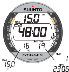
Fig. 3.35. Display alternativo in Surface al termine di un'immersione in Profondimetro/Timer. La finestra indica il tempo di Non-volo.
