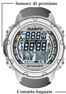
Fig. 2.2. Il contatto bagnato ed il sensore di pressione.
