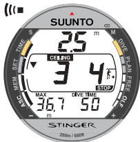
Fig. 3.14. Omissione della sosta di sicurezza obbligatoria. La freccia con la punta rivolta in basso ed un allarme acustico indicano che si dovrebbe ridiscendere alla profondità di Ceiling.
