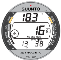
Fig. 3.7. Annotazione punti cospicui. In immersione sono stati annotati punti cospicui premendo il pulsante S (È evidenziato dal simbolo Attenzione)
