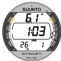
Fig. 3.29 Apnea. La profondità attuale è 6.1 metri, il tempo di immersione è 1.03 minuti e l’immersione in apnea è il numero 1.
