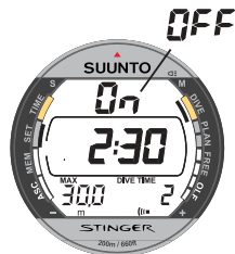
Fig. 4.13. Allarme Tempo di immersione impostato per due minuti e trenta secondi. Il tempo viene visualizzato nella finestra centrale se inferiore ai cinque minuti.
