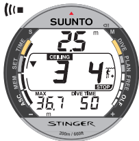
Fig. 3.14. Palier de sécurité obligatoire non respecté. La flèche vers le bas et l'alarme sonore vous informent qu'il faut redescendre à la profondeur indiquée par la mention CEILING.
