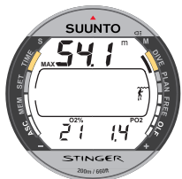
Fig. 3.21. Affichage nitrox. La profondeur maximale calculée en fonction du % O 2 (21%) et de la PO 2 (1.4 bar) est de 54,1 m.
