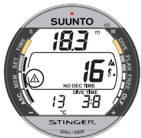
Fig.3.7. Marquage activé. Le repère est placé sur un point du profil de la plongée en appuyant sur le bouton S. Le symbole attention s'affiche au moment où vous appuyez.
