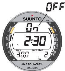
Fig. 4.13. Alarme du temps de plongée. Affichage lorsque le temps de plongée est inférieur à 5 minutes. Le temps s'affiche dans la fenêtre centrale.
