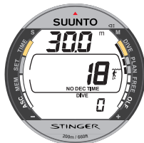
Fig. 3.9. Mode Planning. Le temps de plongée sans palier de décompression à 30.0 m est de 18 minutes en mode A0/P1.
