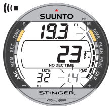
Fig. 3.23. Affichage de la pression partielle et de l'indicateur OLF. Une alarme sonore retentit et le dernier segment de l'indicateur clignote lorsque la valeur OLF a atteint 80%. Lorsque la valeur OLF atteint 100% tous les segments clignotent. Si la valeur OTU est supérieure à celle du CNS, le dernier premier segment clignote.
