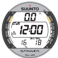
Fig.3.25. Intervalle surface. Ecran alternatif indiquant le temps d'attente avant un déplacement aérien.
