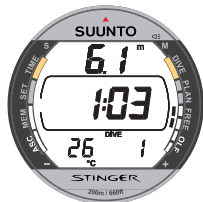
Fig. 3.29. Apnée. La profondeur courante est de 6.1 m, le temps de plongée est de 1.03 minutes et c’est la première immersion.
