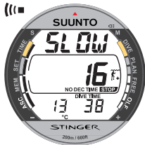
Fig. 3.15. Indicateur de vitesse de remontée. Mention SLOW clignotante et 4 segments affichés: la vitesse de remontée est supérieure à 10 m/min. Il faut ralentir. Le signal STOP signifie que vous devrez effectuer un palier de sécurité obligatoire lorsque la profondeur sera de 6 m.
