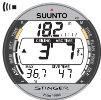
Fig. 3.17. Plongée avec paliers de décompression en-dessous de la profondeur plafond. La flèche pointant vers le haut, la mention clignotante ASC TIME et l'alarme sonore vous recommandent de remonter. La durée totale de remontée minimum incluant le palier de sécurité, est de 7 min. La profondeur plafond est de 3 m.
