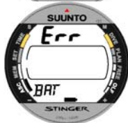
Kuva 3.3. Käynnistys II. Pariston jännitteen osoitin.
