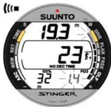
Kuva 3.23. Hapen osapaineen ja OLF:n näytöt. Äänihälytys kuuluu, ja pylväsnäytön viimeinen segmentti alkaa vilkkua, kun OLF saavuttaa 80 prosentin rajan. Kun OLF saavuttaa 100 prosentin rajan, kaikki segmentit alkavat vilkkua. Mikäli OTU-arvo on suurempi kuin CNS-arvo, alin segmentti vilkkuu.
