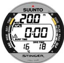
Kuva 3.24. Pintanäyttö. Olet pintaautunut 18 minuuttia kestäneestä sukelluksesta, jonka enimmäissyvyys oli 20,0 m. Nykyinen syvyys on 0,0 m ja pinta-aika on 0. Lentokoneen symboli osoittaa, ettei saa lentää, ja sukeltajan huomiomerkki osoittaa, että sinun on pidennettävä pinta-aikaa, koska mikrokuplia on liikaa.
