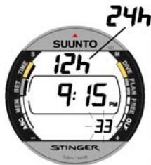
Kuva 4.3. Kellonajan asetustila aktivoituu, ja sekunnit vilkkuvat. Näyttö I.
