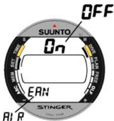
Kuva 4.8. EAN-toimintotilan (nitroksi) On/Off-kytkentä.
