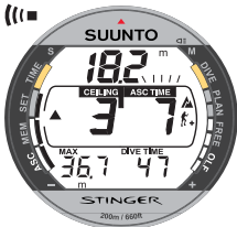
Kuva 3.17. Dekompressiosukellus lattiasyvyuden alapuolella. Ylöspäin osoittava nuoli, vilkkuva ASC TIME -teksti sekä äänihälytys kehottavat sinua nousemaan. Kokonaisnousuaika turvapysähdys mukaan luettuna on vähintään 7 minuuttia. Katto on 3 metrin syvyydessä.
