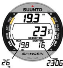
Kuva 3.11. Sukellusnäyttö. Nykyinen syvyys on 19,3 m ja suoranousun enimmäisaika on 23 minuuttia tilassa A0/P1. Sukelluksen enimmäissyvyys oli 19,8 m ja kulunut sukellusaika on 16 minuuttia. Vuorottelevat näytöt esittävät lämpötilan ja kellonajan.
