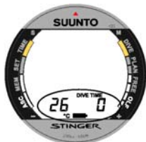
Kuva 3.6. Alhaisen paristojännitteen varoitus. Paristosymboli osoittaa, että pariston jännite on loppumassa ja että pariston vaihtoa suositellaan.
