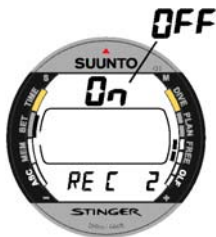
Kuva 4.11. Vapaasukelluksen toimintotilan On/OFF-kytkentä ja rekisteröintivälin asetus.
