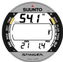
Kuva 3.21. Nitroksin näyttö. Asetettuun happiprosenttiin (O 2 %, 21 %) ja hapen osapaineeseen (PO 2 , 1,4 bar) perustuva enimmäissyvyys on 54,1 m.
