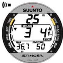
Kuva 3.14. Pakollinen turvapysähdys on laiminlyöty. Alaspäin osoittava nuoli ja äänimerkki osoittavat, että sinun on laskeuduttava kattovyöhykkeelle.
