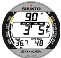
Kuva 3.18. Dekompressiosukellus lattiasyvyuden yläpuolella. Ylöspäin osoittava nuoli on kadonnut, ja nousuaika ASC TIME on lakannut vilkkumasta. Tämä osoittaa, että olet dekompressioalueella.
