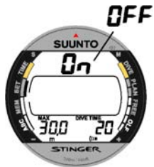
Kuva 4.14. Sukellusajan hälytys. Näyttö, kun sukellusaikaa on jäljellä yli viisi minuuttia.
