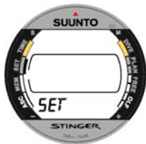
Kuva 4.1. Asetustila osoitetaan tekstillä SET sekä toimintotilan osoittimella.
