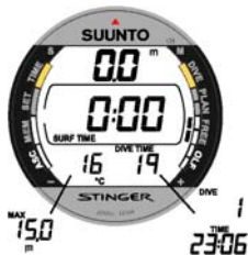
Kuva 3.34. Pinnanäyttö mittarisukelluksen jälkeen. Keski-ikkunassa näkyy pinta-aika.
