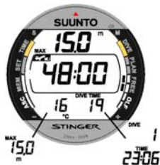
Kuva 3.35. Vuorotteleva näyttö mittarisukelluksen jälkeen. Keski-ikkunassa näkyy lentoaika.
