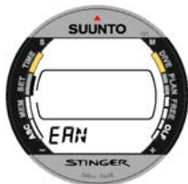
Kuva 4.7. EAN/Air (nitroksi/paineilma) asetustila.
