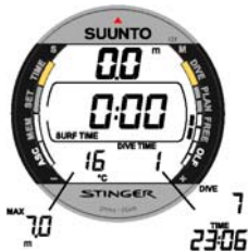
Kuva 3.32. Pintanäyttö vapaa-sukelluksen jälkeen. Keski-ikkunassa näkyy pinta-aika.
