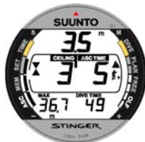
Kuva 3.19. Dekompressiosukellus lattiasyvyydellä. Kaksi nuolta osoittaa toisiaan ("tiimalasi"). Olet optimaalisella kattovyöhykkeellä 3,5 metrin syvyydessä, ja lyhin nousuaika on 5 minuuttia.
