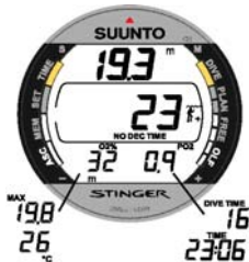
Kuva 3.22. Sukeltaminen nitroksitilassa. Happiprosentiksi (O 2 %) on asetettu 32 %.
