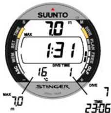
Kuva 3.33. Vuorotteleva pintanäyttö vapaasukelluksen jälkeen. Keski-ikkunassa näkyy viimeisimmän sukelluksen sukellusaika.
