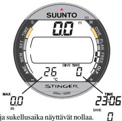
Kuva 3.5. Käynnistys IV. Vapaasukellus/mittaritila. Syvyys ja sukellusaika näyttävät nollaa. Painamalla +/-painiketta pääset vuorottelevaan näyttöön, jossa on enimmäissyvyys ja nykyinen kellonaika tai sukelluksen järjestysnumero.
