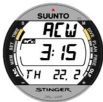
Kuva 2.3. Aktivoitu vesikontakti ilmaistaan tekstillä ACW.
