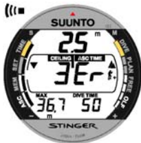
Kuva 3.20. Dekompressiosukelus kattosyvyyden yläpuolella. Huomaa alaspäin osoittava nuoli, Er-varoitus sekä äänihälytys. Sinun on laskeuduttava välittömästi (3 minuutin sisällä) kattosyvyyteen tai sen alapuolelle.
