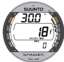
Kuva 3.9. Sukelluksen suunnittelu. Suoranoususukelluksen aikaraja 30 metrissä on 18 min P0/A0-tilassa.
