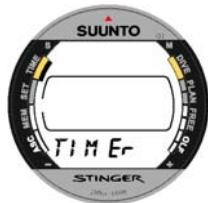
Kuva 2.6. Ajanottotoiminto osoitetaan tekstillä TIMER ja toimintotilan osoittimella.
