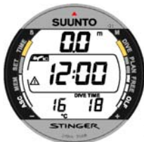
Kuva 3.24. Pintanäyttö. Olet pintaautunut 18 minuuttia kestäneestä sukelluksesta, jonka enimmäissyvyys oli 20,0 m. Nykyinen syvyys on 0,0 m ja pinta-aika on 0. Lentokoneen symboli osoittaa, ettei saa lentää, ja sukeltajan huomiomerkki osoittaa, että sinun on pidennettävä pinta-aikaa, koska mikrokuplia on liikaa.
