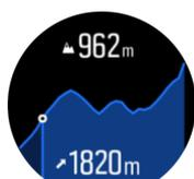
Si te alejas demasiado de la ruta mientras usas la navegación de altitud, tu reloj te avisará con un mensaje **Fuera de ruta** en la pantalla de perfil de altitud. Si ves este mensaje, desplázate hasta la pantalla de navegación de ruta para corregir el rumbo antes de continuar con la navegación de altitud.
