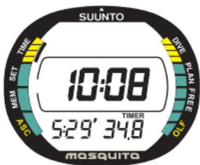
Fig. 2.7. Il cronometro visualizza ore, minuti e secondi.
