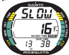
Fig. 3.15. Indicatore di velocità di risalita. Le indicazioni: profondità attuale lampeggiante, l'apparire della scritta SLOW, i quattro segmenti attivi contemporaneamente unitamente ad un segnale acustico indicano che la velocità di risalita supera i 10 m/min. [33 ft/min.]. È un allarme che indica di rallentare la risalita! La scritta STOP indica che il subacqueo deve effettuare una sosta di sicurezza obbligatoria quando raggiunge la profondità di 6 m. [20 ft].
