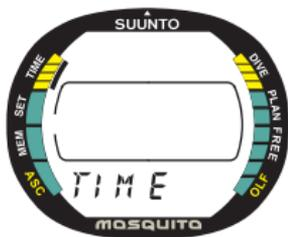
Fig. 2.4 Il programma Time è indicato sullo schermo con la scritta TIME e dall'indicatore di funzione del display.
