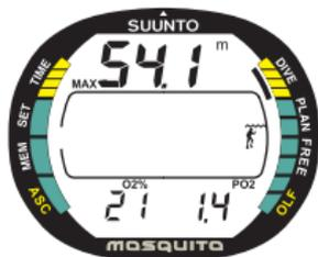
Fig. 3.21. Display Nitrox. La massima profondità ammissibile, calcolata in base alla % di  $O_2$  (21%) ed alla  $PO_2$  (1,4 bar), è m. 54,1 [177 ft].
