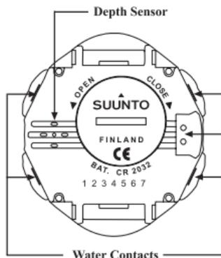
Fig. 2.2. Il contatto bagnato ed il sensore di pressione.
