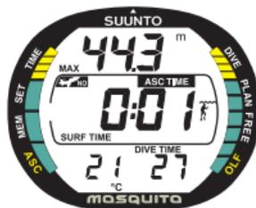
Fig. 3.26. Surface dopo omessa decompressione. Il simbolo ASC TIME indica che la quota di Ceiling è stata violata per oltre 3 minuti. Il display alternativo indica di non immergersi per almeno 48 ore.
