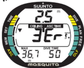
Fig. 3.20. Immersione con decompressione, al di sopra del Ceiling. Notare la freccia rivolta verso il basso, l'allarme Er ed un segnale acustico. Entro al massimo 3 minuti si deve ridiscendere alla profondità del Ceiling o più profondi.
