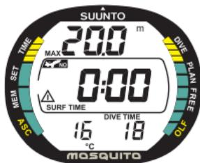
Fig. 3.24. display in Superficie. Il tempo totale d'immersione è stato 18 min. ed è stata raggiunta la profondità massima di 20.0 m [66 ft]. La profondità attuale è 0.0 m e l'intervallo di superficie è 0 min. L'icona dell'aeroplano indica che non si possono effettuare viaggi aerei ed il simbolo di Attenzione sta ad indicare che è necessario prolungare l'intervallo di superficie a causa di eccesso di formazione di microbolle.
