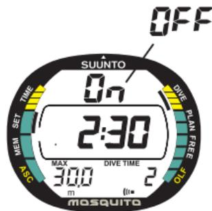
Fig. 4.11. Allarme Tempo di immersione. La finestra centrale del display indica meno di 5 minuti di tempo d'immersione.
