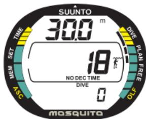
Fig. 3.9. Pianificazione. Il tempo di non decompressione a 30.0 m [100 ft] è 18 minuti in PO/AO.
