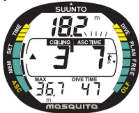
Fig. 3.17. Immersione con decompressione, più profondi di Floor. La freccia con la punta rivolta verso l'alto, la scritta ASC TIME lampeggiante ed un segnale acustico indicano che è opportuno risalire. Il tempo totale di risalita minimo, inclusa la sosta di sicurezza, è 7 minuti. Il Ceiling è a 3 m [10 ft].
