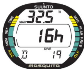
Fig. 5.9. Memoria Storica immersioni con autorespiratore. Numero totale d'immersioni, ore d'immersione e massima profondità raggiunta.
