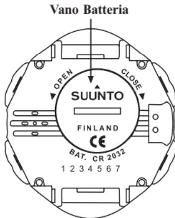
Fig. 6.1. Coperchio del vano batteria.
