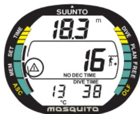
Fig. 3.7. Annotazione del punto. Durante l'immersione, premendo il pulsante
