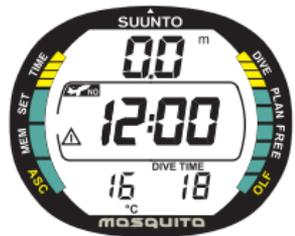
Fig. 3.25. Display in superficie. Il display alternativo che indica il tempo di No-Fly.
