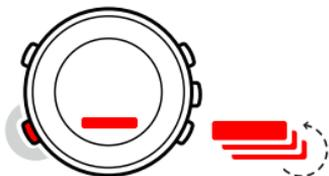
Einige Ansichten sind interaktiv. Suunto Lumi ist mit drei interaktiven Ansichten ausgestattet: mit der Stoppuhr im Modus **TIME**, dem Protokollrecorder sowie dem Höhendifferenzmesser im Modus **ALTI&BARO**. Sie können die interaktiven Ansichten mit der Taste [Start Stop] oben links starten, stoppen und neu starten. Um die Ansicht zurückzusetzen, drücken Sie die Taste [Up] rechts oben, bis die Anzeige gelöscht wird. Wechseln Sie in den Modus **TIME** und probieren Sie sie aus!
