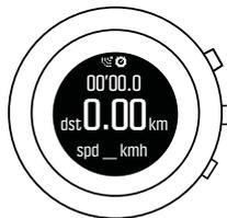
È possibile modificare la visualizzazione della riga inferiore premendo il pulsante inferiore. Premere il pulsante centrale per la navigazione verso una posizione specifica (consultare 3.10. *Torna alla partenza*).
