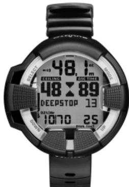
Благодаря функциям планирования погружения на ПК и переключения между газами подводный компьютер Suunto HelO<sub>2</sub> упрощает процесс погружения за счет объединения на одном удобном для считывания информации экране всех данных о глубине, времени, давлении в баллоне и статусе декомпрессии.
