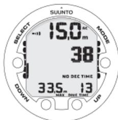
ДИСПЛЕЙ ПОГРУЖЕНИЯ - ТЕКУЩАЯ ГЛУБИНА 15 М, МАКС. ГЛУБИНА ПОГРУЖЕНИЯ РАВНА 33,5 М И БЕЗДЕКОМПРЕССИОННЫЙ ПРЕДЕЛ ВРЕМЕНИ РАВЕН 38 МИН. С НАЧАЛА ПОГРУЖЕНИЯ ПРОШЛО 13 МИН.
