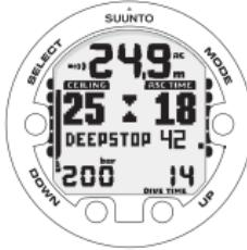
DURANTE A SUBIDA, É INFORMADO PARA EFECTUAR UMA PARAGEM DE PROFUNDIDADE AOS 25 M COM A DURAÇÃO MOSTRADA PELO TEMPORIZADOR (42 SEGUNDOS RESTANTES).
