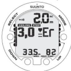
MERGULHO DE DESCOMPRESSÃO, ACIMA DO LIMITE SUPERIOR. NOTE A SETA A APONTAR PARA BAIXO, ALARME E AVISO ER. DEVE DESCER IMEDIATAMENTE (NO PRAZO DE 3 MINUTOS) PARA 0, OU ABAIXO DO, LIMITE SUPERIOR.
