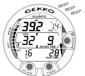
Bild 3.23. Display för syrets partialtryck och OLF. En ljussignal hörs om syrets partialtryck stiger över 1,4 bar eller det inställda värdet och/eller om OLF når 80 %.
