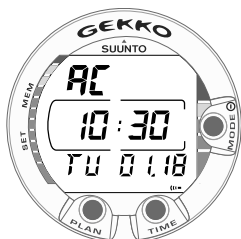
Bild 2.4. Aktiva vattenkontakter anges med texten AC.
