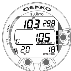
Bild 3.11. Indikator för uppstigningshastigheten. Högsta tillåtna uppstigningshastighet. Fyra segment.
