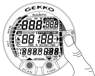
Bild 3.1. Igångsättning I. Alla segment visas.
