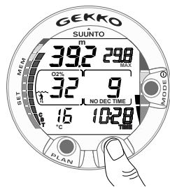
Fig. 3.24. Affichage alterné. En appuyant sur le bouton TIME l'heure, la profondeur maximale, la température, le CBT (temps de plongée écoulé) et le 02%.
