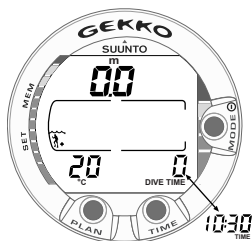
Fig. 3.3. Mise en marche III. Affichage Mode Surface. La profondeur et le temps de plongée sont à zéro, la température est de 20°C. En appuyant sur le bouton TIME, l'écran alterné affiche l'heure et la température.
