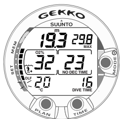
Fig. 3.22. Plongée nitrox. L'02% est réglé à 32%.
