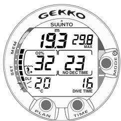
Fig. 3.25. L'OTU atteint la limite de toxicité. Le segment inférieur clignote et une alarme sonore retentit.
