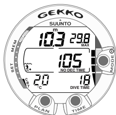
Fig. 3.11. Indicateur de vitesse de remontée. Vitesse maximale autorisée. Quatre segments.
