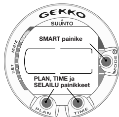
Fig. 2.2. Les boutons-poussoirs de l'ordinateur.
