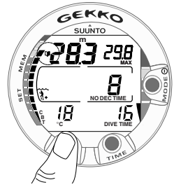
Fig. 3.8 Marquage activé. Le repère est placé sur un point du profil de la plongée en appuyant sur le bouton PLAN. Le symbole du carnet de plongée s'affiche au moment où vous appuyez.
