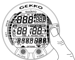
Fig. 3.1. Mise en marche I. Tous les segments apparaissent.
