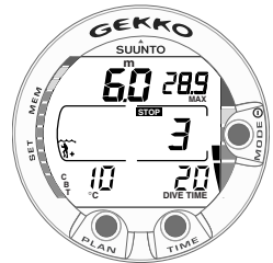
Fig. 3.9. Palier de sécurité recommandé de 3 minutes.
