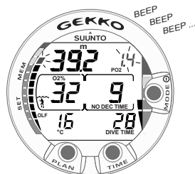
Fig. 3.23. Affichage de la pression partielle d'oxygène et de l'indicateur OLF. Une alarme sonore retentit quand la pression partielle est supérieure à 1.4 bar ou à la valeur choisie, l'indicateur OLF a atteint 80%.
