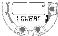
Fig. 3.2. Mise en marche II. Indicateur de niveau de pile.
