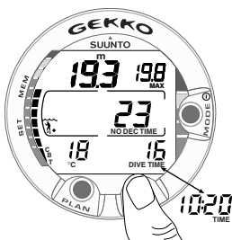
Kuva 3.7. Sukellusnäyttö. Tämänhetkinen syvyys on 19,3 metriä, ja suoranousajan raja on 23 minuuttia A0/P1 –tilassa. Tämän sukelluksen aikana enimmäissyvyys oli 19,8 metriä, veden lämpötila on 18° C, ja kulunut sukellusaika on 16 minuuttia. Nykyisen kellonajan 10:20 vuorotteleva näyttö näytetään 5 sekunnin ajan sen jälkeen, kun TIME –painiketta on painettu.
