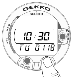
Kuva 2.1. Kellonajan näyttö. Näyttö aktivoituu, kun painat PLAN tai TIME -painiketta.
