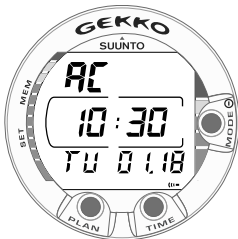
Kuva 2.4. AC -teksti on merkinä aktiivisista vesi- kontakteista.
