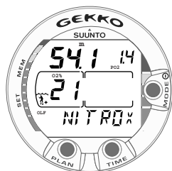
Kuva 3.22. Sukeltaminen nitroksitilassa. Happipitoisuuden arvoksi on asetettu 32%.
