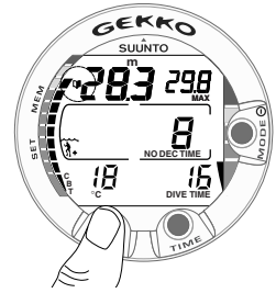
Kuva 3.8. Sukeltajan oman merkinnän aktivointi. Merkintä sijoitetaan profilimuistiin sukelluksen aikana painamalla PLAN-painiketta. Huomaa lokikirjasynti.
