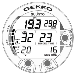
Kuva 3.25. Alin pylväsdiaagrammi vilkkuu merkinä siitä, että näytetty happikertymän (OLF) arvo koskee happitoleranssia (OTU).
