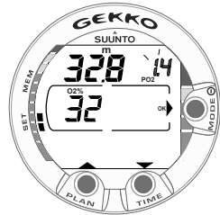
Kuva 4.17. Nitroksiparametrien asetus, happipitoisuus on 32%, hapen osapaineen raja on 1,4 bar. Vastaava enimmäissyvyys näytetään arvona 32,8 m. Paina selauspainikkeita halutessasi muuttaa happipitoisuutta ja määrittää hapen osapaineen asetusarvon. Hyväksy asetukset painamalla MODE (OK).
