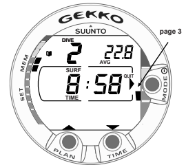
Kuva 4.8. Lokikirjan näyttö III. Sukellusten välinen pinta-aika ja keskimääräinen syvyys
