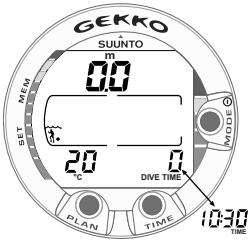
Kuva 3.3. Käynnistys III. Pintatila. Syvyys ja sukellusaika ovat nollassa, tämänhetkinen lämpötila 20°C. Painamalla TIME –painiketta aktivoit nykyisen kellonajan vuorottelevan näytön.
