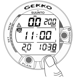
Kuva 3.28. Sukellusten välinen pinta-aika, lentokieltoaika. Painamalla TIME-painiketta kahdesti saat näytölle lentokieltoajan, jonka merkinä on lentokonesymboli.
