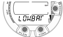
Kuva 3.2. Käynnistys II. Pariston jännitteen ilmaisin.
