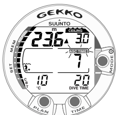
Kuva 3.15. Etappisukellus lattian alapuolella. Ylöspäin osoittava nuoli, vilkkuva ASC TIME –merkki sekä äänihälytys ilmoittavat, että sinun tulee nousta. Yhteenlaskettu vähimmäisnousuaika turvapysähdykset mukaan luettuna on 7 minuuttia. Katto on 3 metrissä.
