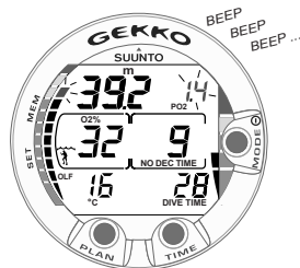
Kuva 3.23. Hapen osapaineen ja happikertymän (OLF) näytöt. Kuuluu äänihälytys, kun hapen osapaine ylittää arvon 1,4 bar tai asetetun arvon ja/tai OLF on saavuttanut 80% rajan.
