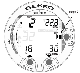
Kuva 4.7. Lokikirjan näyttö II. Tärkeimmät sukellusta koskevat tiedot.
