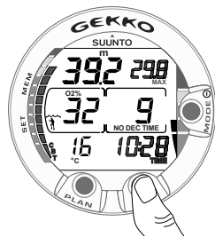
Kuva 3.24. Vuorotteleva näyttö. Painamalla TIME-painiketta näyttö tulee nykyinen kellonaika, enimmäissyvyys, lämpötila, CBT ja O 2 %.
