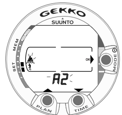
Kuva 4.25. Korkeusluokan asetus. Paina selauspainikkeita halutessasi muuttaa korkeusluokkaa.
