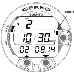
Kuva 4.6. Lokikirjan näyttö I. Selaa määrätyn sukelluksen eri näyttöjä.
