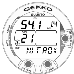
Kuva 3.20. Nitroksinäyttö. Asetettuihin happipitoisuuden (21%) ja hapen osapaineen (1,4 bar) arvoihin perustuva enimmäissyvyys on 54,1 m.
