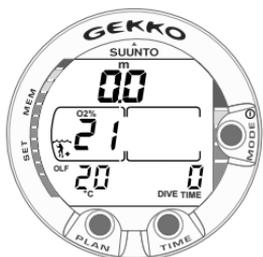
Abb. 3.21. Oberflächenanzeige im Nitrox-Modus.
