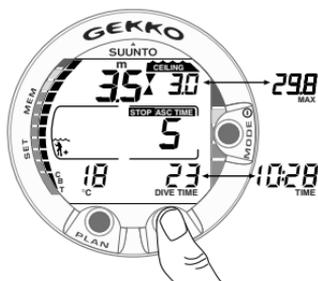
Abb. 3.17. Dekompressionstauergang innerhalb der Dekompressionszone. Zwei gegeneinander gerichtete Pfeile (Sanduhr) erscheinen. Sie befinden sich im optimalen Deko-Bereich in 3,5m [11ft] Tiefe und Ihre minimale Aufstiegszeit beträgt 5 Minuten. Durch Drücken des TIME-Kontaktes können Sie die maximale Tiefe, Uhrzeit und Temperatur ablesen.
