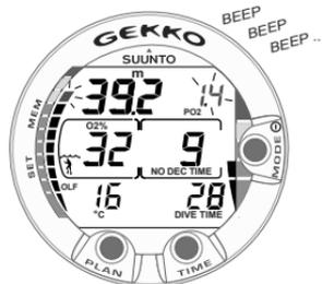
Abb. 3.23. Sauerstoffpartialdruck und OLF-Anzeige. Ein akustischer Alarm ertönt, weil der Sauerstoffpartialdruck grösser als 1,4 bar ist, bzw. weil der eingestellte Wert und der Sauerstoffgrenzbereich (OLF) 80 % erreicht haben.
