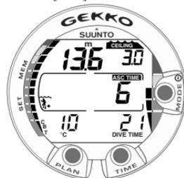
Abb. 3.16. Dekompressionstauchgang oberhalb der Dekompressionsgrenze. Der aufwärts gerichtete Pfeil ist verschwunden und ASC TIME blinkt nicht mehr, d.h. Sie befinden sich im Dekompressionsbereich.
