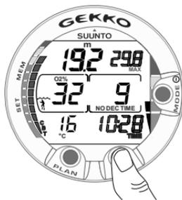
Abb. 3.24. Alternative Anzeige. Nach Drücken des TIME-Kontakts werden die aktuelle Uhrzeit, die maximale Tiefe, Wassertemperatur, CBT und O<sub>2</sub>% angezeigt.
