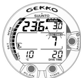
Abb. 3.15. Dekompressionstauchgang unterhalb der Dekompressionsgrenze. Der aufwärts gerichtete Pfeil und die blinkende Anzeige ASC TIME weisen Sie darauf hin, aufzusteigen. Die minimale Aufstiegszeit beinhaltet den Sicherheitsstopp und beträgt 7 Minuten. Die Deko-Stufe liegt bei 3m [10ft].
