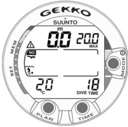
Abb. 3.26. Anzeige im Oberflächenmodus. Sie haben einen 18- minütigen Tauchgang durchgeführt, dessen maximale Tiefe 20,0m [66ft] betrug. Ihre aktuelle Tiefe ist 0,0m [0ft]. Das Flugverbots-Symbol zeigt, dass Sie nicht fliegen sollten und das ACHTUNG-Symbol weist Sie darauf hin, dass Sie Ihre Oberflächenpause wegen des Auftretens von Mikroläschen verlängern sollten.
