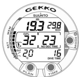
Abb. 3.22. Tauchen im Nitrox-Modus. O2% ist auf 32% eingestellt.
