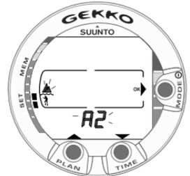
Abb. 4.25. Einstellen des Höhenmodus. Drücken Sie PLAN und TIME, um den Höhenmodus zu verändern.
