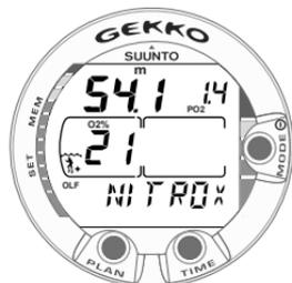
Abb. 3.20. Nitrox- Anzeige. Die maximale Tiefe basierend auf den Einstellungen O2% (21%) und PO2 (1,4 bar) beträgt 54,1 m [177ft].
