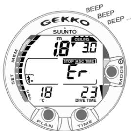
Abb. 3.18. Dekompressionstauergang oberhalb der Dekompressionsstufe. Beachten Sie den abwärts gerichteten Pfeil und die "Er"-Warnung. Ausserdem hören Sie einen akustischen Alarm. Sie sollten sofort (innerhalb von 3 Minuten) mindestens auf die vorgeschriebene Deko-Stufe abtauchen.
