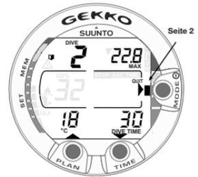
Abb. 4.7. Logbuch, Seite II. Die hauptsächlich relevanten Daten des Tauchgangs.
