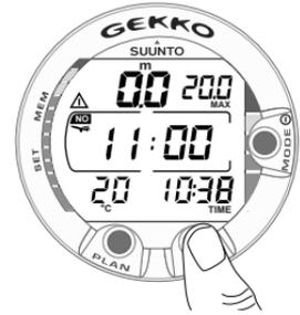
Abb. 3.28. Oberflächenintervall, Flugwarnung. Ein zweimaliges Drücken des TIME-Kontaktes zeigt die Zeit bis zum Ablauf der Flugverbotszeit an, symbolisiert durch ein Flugzeug.
