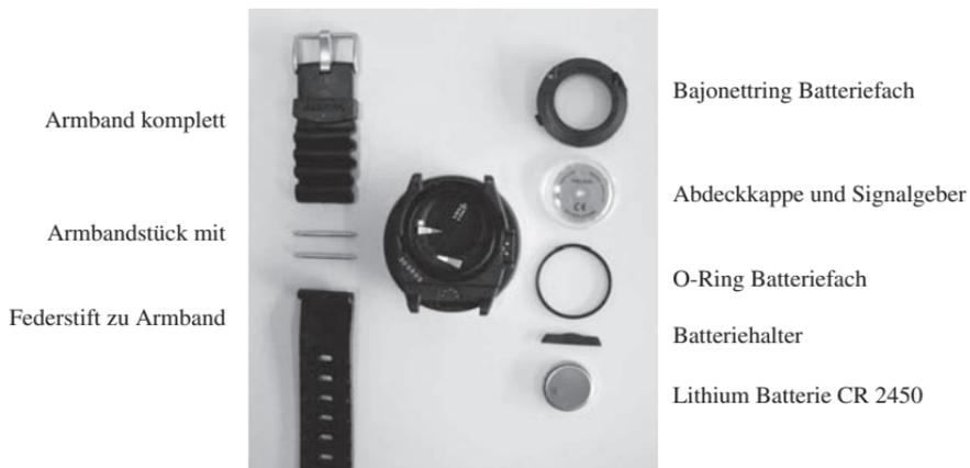
Abb. 5.1. Teile der Konsole.
