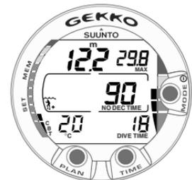
Abb. 3.10. Aufstiegs geschwindigkeitsanzeige. Drei Segmente.
