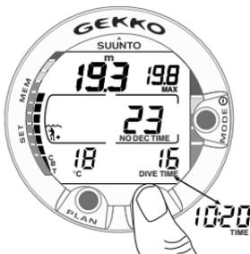
Abb. 3.7. Anzeige während des Tauchgangs. Die aktuelle Tiefe ist 19,3 m und die Nullzeit beträgt im Modus A0/P1 23 Minuten. Die maximal bei diesem Tauchgang erreichte Tiefe war 19,8 m, bisherige Tauchzeit ist 16 Minuten und die Wassertemperatur beträgt 18°C [64°F]. Nach Drücken des TIME-Kontakts wird die aktuelle Uhrzeit 10:20 [10:20am] für 5 Sekunden angezeigt.
