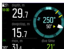
Под курсом (большие цифры в центре компаса) также отображается относительная разница между азимутом и курсом. Следовательно, например, при необходимости следования в определенном направлении по курсу нижняя цифра должна быть 0.
