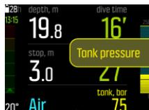
Когда давление в баллоне падает ниже 50 бар (720 фунтов на кв. дюйм), то текущее давление в баллоне отображается красным цветом в окне переключения и подается обязательный предупредительный сигнал:
