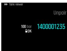
4. Убедитесь, что Tank POD активирован: на экране должно отображаться давление в баллоне, а зеленый светодиод POD должен мигать.
