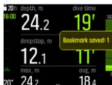
В закладках сохраняются следующие сведения: отметка времени, глубина, температура и давление, использование устройства Tank POD. Эти данные отображаются в приложении Suunto после погружения.
