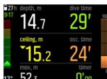
以下の例では、減圧シーリング深度は 12.4 m で、現在の深度は 11.0 m です。ダイバーは減圧ゾーンの範囲外にいるため、潜降する必要があります。ダイバーにシーリング深度よりも深く潜降するよう促す赤い矢印が表示されてアラーム音が鳴り、シーリング深度を示す数字も赤色に変わります。
