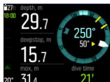
ヘディング ( コンパスの中央の大きい数字 ) の下に、ベアリングとヘディングの相対偏差も表示されます。したがって、たとえばベアリングの方向にまっすぐ向かう場合、下の数字は0°になります。
