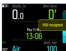
ダイブメインビューでは、使用中のガスに該当するタンク圧のみが表示されます。ガスを変更すると、それに応じて表示される残圧も変わります。
