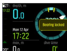
ベアリングをロックしたら、以下のようにコンパスローズにロック位置が表示されます。
