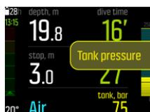
タンク圧が 50 bar ( 720 psi ) を下回ると、切り替えウィンドウに表示される実際のタンク圧の値が赤になり、必然的にアラームがトリガーされます。
