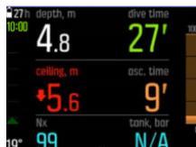
そのような場合には、ただちにシーリング深度より下に戻り、減圧を続けてください。3分以内にシーリング深度の下に戻らない場合、Suunto EON Steel Black がアルゴリズム計算をロックし、下に示すように、「ロック」と表示されます。また、シーリングも表示されなくなるので注意してください。
