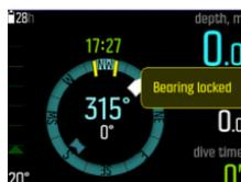
Una vez que fijaste el rumbo, la posición fijada se indica en los grados de brújula tal y como se muestra a continuación.
