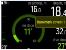
Los marcadores guardan la siguiente información: marca de hora, profundidad, temperatura, y presión si se usa un Tank Pod. Los datos se pueden ver en la app Suunto tras la inmersión.
