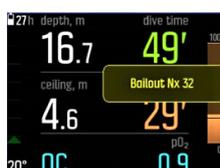
Si el mal funcionamiento se corrige o la situación de la inmersión se normaliza, podrás cambiar de vuelta a un diluyente utilizando el mismo procedimiento que aparece anteriormente, pero seleccionando de **gases de CC**.
