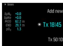
Si estás buceando con un solo gas, asegúrate de tener ese gas en el menú **Gases**. De lo contrario, Suunto EON Steel espera que utilices todos los gases de la lista y te indica que cambies de gas durante la inmersión.
