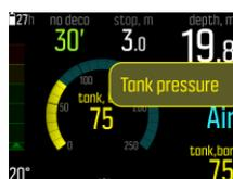
Cuando la presión de la botella baja a menos de 50 bares (720 psi), el valor real de presión de la botella se indica en rojo en la ventana de cambio y se dispara una alarma obligatoria:
