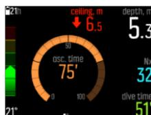
En este caso, deberás descender por debajo del nivel del techo para continuar la descompresión. Si no lo haces en los (3) minutos siguientes, el Suunto EON Steel bloquea el cálculo del algoritmo y muestra en su lugar el mensaje **Bloq.**, según se muestra a continuación. Como ves, el valor de techo ya no está presente.
