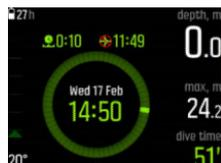
El tiempo de espera para volar es el tiempo mínimo en superficie recomendado después de una inmersión antes de volar en avión. Siempre es de al menos 12 horas. Para tiempos de desaturación inferiores a 75 minutos no se muestra el tiempo de espera para volar. El tiempo máximo de espera para volar es de 72 horas.
