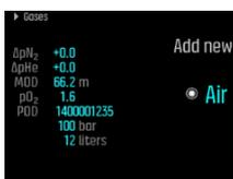
2. Drücke die Mitteltaste, um die Gaseinstellungen zu öffnen, und wähle **Tank POD** aus.
