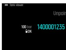
4. Vergewissere dich, dass der Tank POD aktiviert wurde, indem du kontrollierst, ob der Flaschendruck auf dem Display angezeigt wird und die grüne LED des PODs blinkt.
