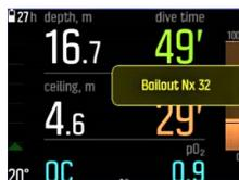
Wenn die Störung behoben ist oder sich die Tauchsituation anderweitig normalisiert hat, kannst du wieder zu einem Diluent wechseln, indem du wie oben beschrieben vorgehst, jedoch aus den **CC-Gasen** auswählst.
