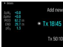
Wenn du mit nur einem Gas tauchst, vergewissere dich, dass nur dieses Gas im Menü **Gase** aufgeführt ist. Andernfalls geht der Suunto EON Steel davon aus, dass du alle Gase in der Liste verwendest und fordert dich während des Tauchgangs zum Gaswechsel auf.
