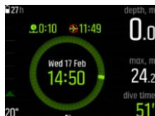
Die Flugverbotszeit ist der Mindestoberflächenzeit, die du nach einem Tauchgang abwarten solltest, bevor du in einem Flugzeug fliegst. Sie beträgt jeweils mindestens 12 Stunden. Bei Entsättigungszeiten unter 75 Minuten wird keine Flugverbotszeit angezeigt. Die maximale Flugverbotszeit ist 72 Stunden.
