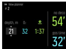
Die berechnete Nullzeit basiert auf der Tauchtiefe und dem Gasgemisch. Hierbei werden eventueller Reststickstoff aus vorangegangenen Tauchgängen und die Oberflächenzeit einbezogen. Die **Gaszeit** richtet sich nach der Tauchtiefe, dem Gasgemisch, dem Verbrauch, der Flaschengröße und dem Flaschendruck.
