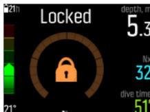
In diesem Status erhöht sich dein Risiko für die Dekompressionskrankheit (DCS) erheblich. Dekompressionsdaten sind für 48 Stunden nach dem Auftauchen nicht verfügbar.
