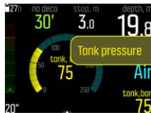
Wenn der Flaschendruck unter 50 bar (720 Psi) gefallen ist, wird der aktuelle Flaschendruckwert im Wechselfenster rot angezeigt und ein obligatorischer Alarm wird ausgelöst:
