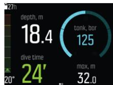
**注釋** 在 Gauge 模式下潛水後，減壓計算將持續鎖定 48 小時。若在此期間，您再度於 Air/Nitrox 模式下潛水，則無法使用潛水演算法和減壓計算，而且 **鎖定** 會顯示在螢幕上。
