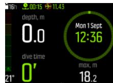
禁止飛行時間表示潛水之後的最少岸上時間，在搭機飛行之前，建議最好等待此段時間。至少為 12 小時。若脫飽和時間少於 75 分鐘，則不會顯示禁止飛行時間。禁止飛行時間最長為 72 小時。
