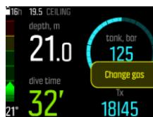
**警告** 當以多種氣體進行潛水時，請記住，上升時間的計算始終基於使用 **氣體** 選單所示的所有氣體之假設。在潛水前，請務必確認您只定義了目前規劃潛水的氣體。移除不可用於潛水的氣體。
