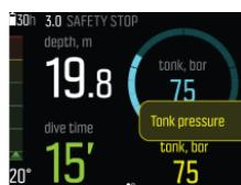
氣瓶壓力降至 50 bar 以下，且切換視窗中的實際氣瓶壓力值顯示紅色時，會觸發強制警報：
