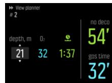
計算的免減壓時間則是根據潛水深度及混合氣體為基準。上次潛水的任何殘餘氮氣及岸上時間會納入考量。**氣體時間** 取決於潛水深度、混合氣體、個人消耗量、氣瓶大小及氣瓶壓力。
