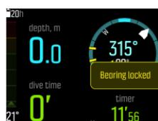
待您鎖定方位後，鎖定位置隨即顯示於羅盤面上，如下所示。
